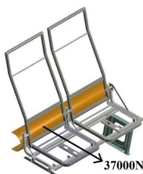
Fig. 4.45: Aplicación de la carga de 37000 N (Fuente: Autor)
