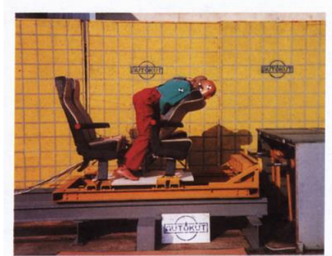
Fig. 2.4: Estudio de impacto con la máquina de pruebas dinámicas [10]
