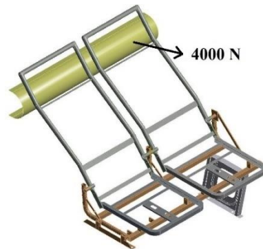
Fig. 4.82: Aplicación de la carga de 4000 N (Fuente: Autor)
