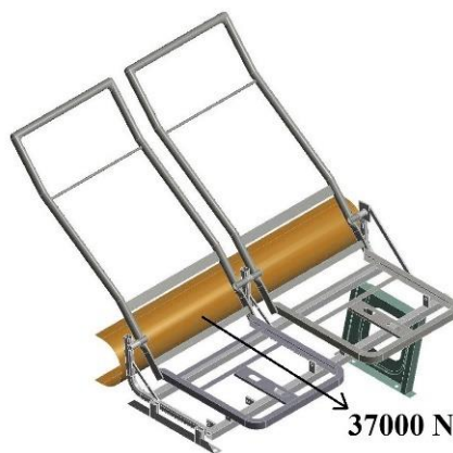
Fig. 4.31: Aplicación de la carga de 37000 N (Fuente: Autor)
