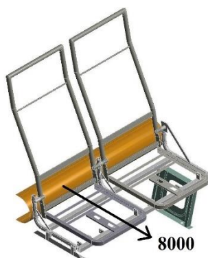
Fig. 4.87: Aplicación de la carga de 8000 N (Fuente: Autor)
