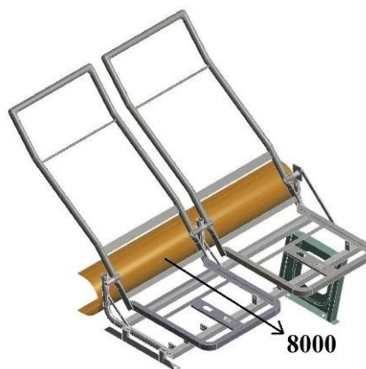
Fig. 4.73: Aplicación de la carga de 8000 N (Fuente: Autor)
