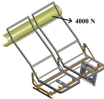
Fig. 4.64: Aplicación de la carga de 4000 N (Fuente: Autor)
