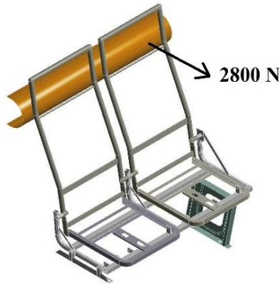
Fig. 4.17: Aplicación de la carga de 2800 N (Fuente: Autor)
