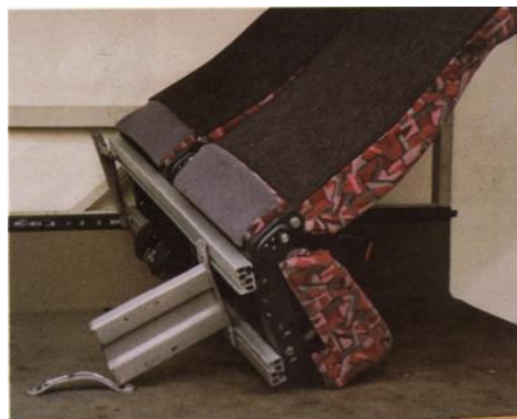
Fig. 2.5: Estudio de impacto con la máquina de pruebas dinámicas [10]
