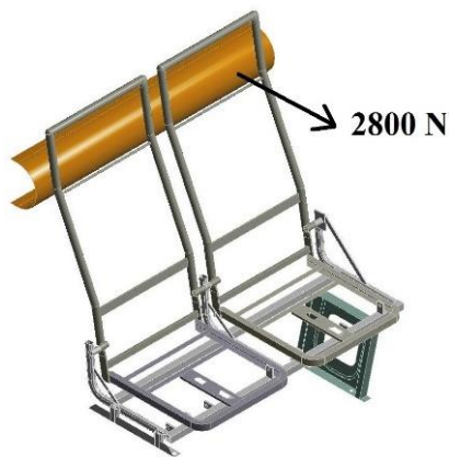
Fig. 4.35: Aplicación de la carga de 2800 N (Fuente: Autor)
