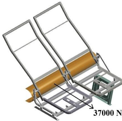
Fig. 4.49: Aplicación de la carga de 37000 N (Fuente: Autor)
