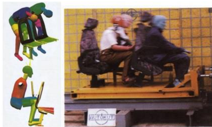
Fig. 2.7: Comportamiento numérico del análisis dinámico [10]
