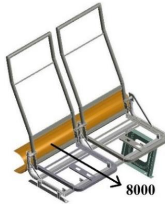
Fig. 4.69: Aplicación de la carga de 8000 N (Fuente: Autor)
