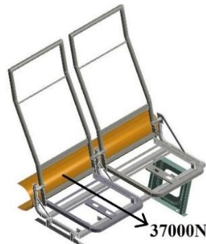
Fig. 4.27: Aplicación de la carga de 37000 N (Fuente: Autor)
