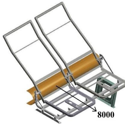
Fig. 4.91: Aplicación de la carga de 8000 N (Fuente: Autor)
