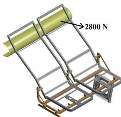
Fig. 4.40: Aplicación de la carga de 2800 N (Fuente: Autor)
