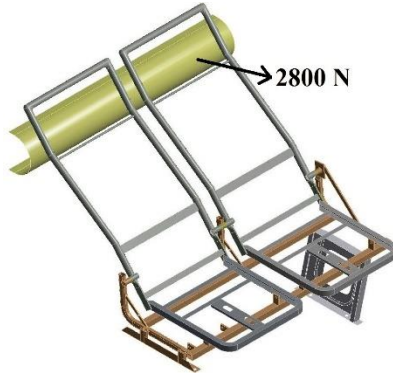
Fig. 4.22: Aplicación de la carga de 2800 N (Fuente: Autor)
