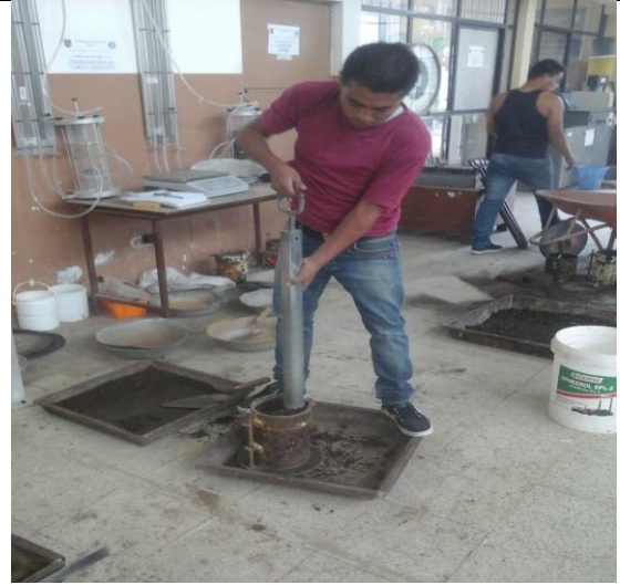
Realizando la compactación por capas
