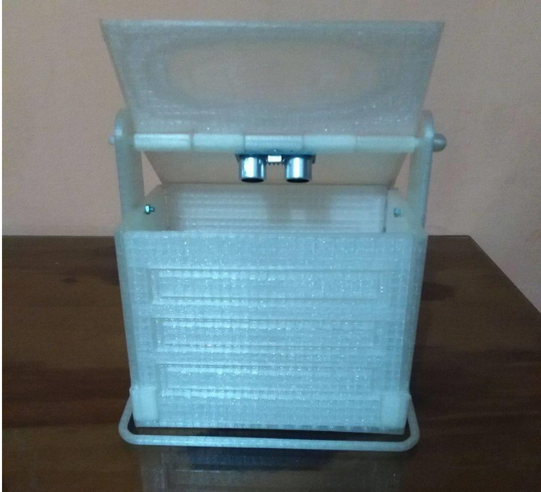
Fig.1: Ubicación del sensor ultrasonico HC-SR04 en el ecotacho vista frontal
