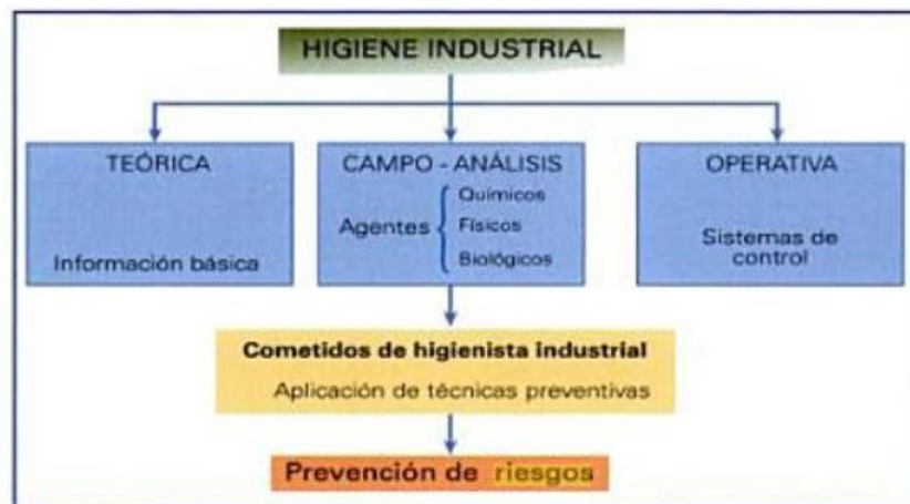
Figura 6. Esquema de los tipos de Higiene Industrial ligadas entre sí, (de acuerdo con Cortes J.2012). Fuente: Riesgos químicos y biológicos ambientales
