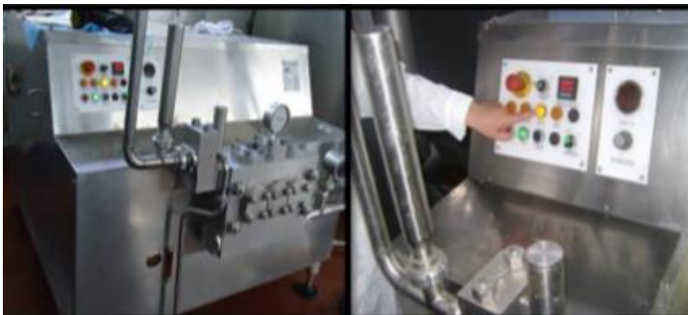
Fotografía 9. Homogenizacion de la leche fermentada
