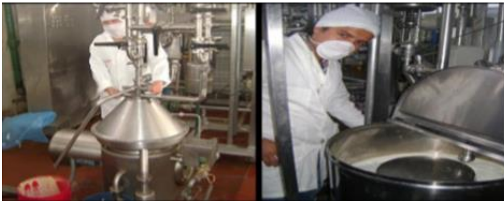
Fotografía 9. Homogenizacion de la leche fermentada
