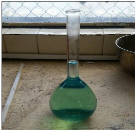
Figura N° 11. Ensayo para determinar la Gravedad Específica del Cemento
