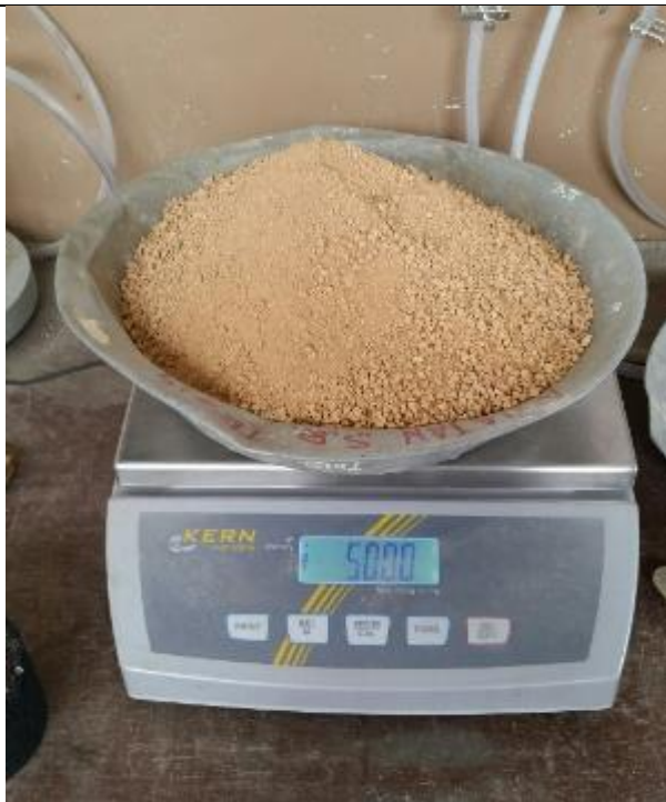
Pesaje de 6000 gramos de suelo para realizar ensayo
