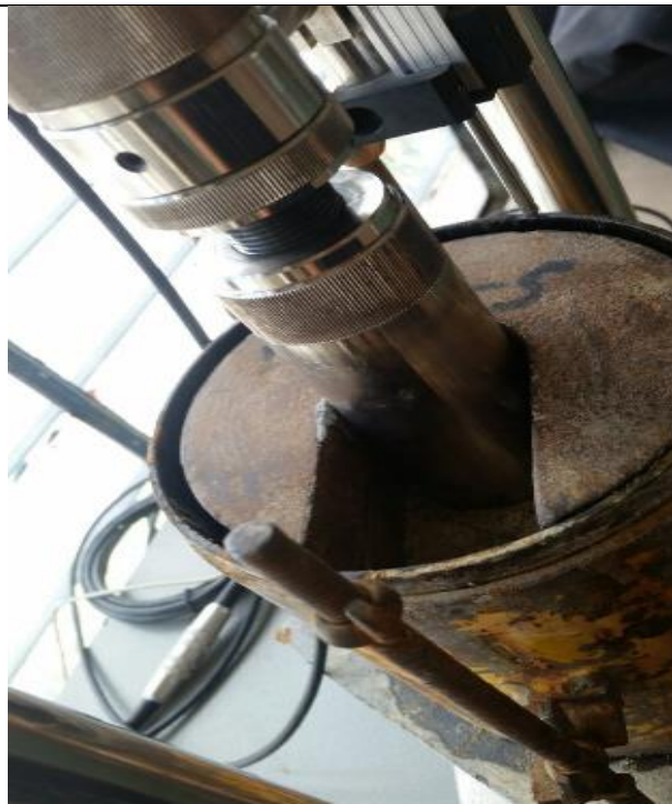
Colocación de ensayo en máquina para determinar CBR
