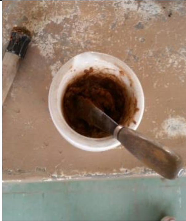
Mezclado de suelo más agua para realizar ensayo
