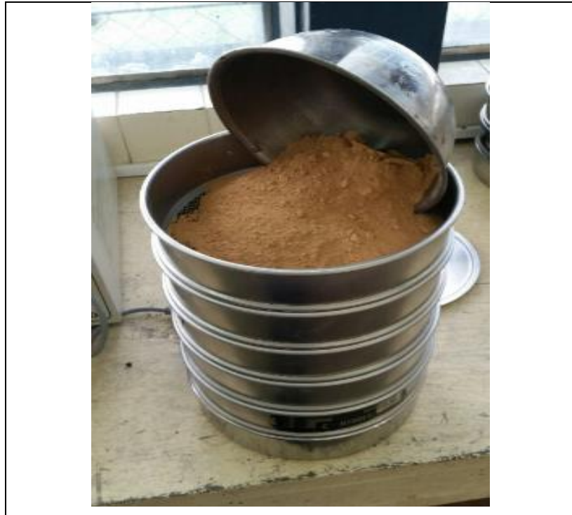
Colocación del suelo en tamices
