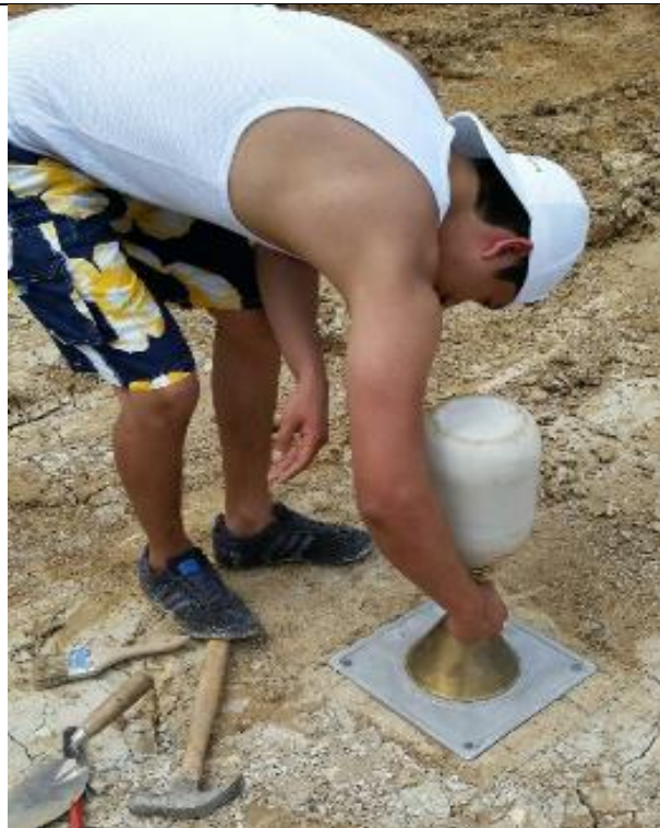
Colocación de Arena de Ottawa en agujero realizado / Muestra Barrio El Chofer
