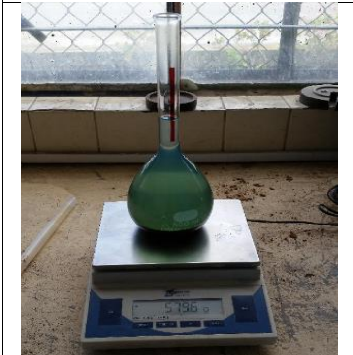
Pesaje de Picnómetro + cemento
