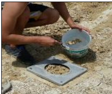
Figura N° 9. Extracción de suelo/Ensayo de cono y arena
