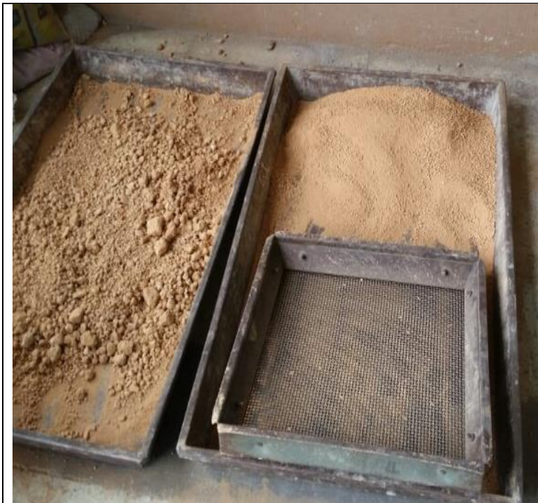
Tamizado de suelo por tamiz No.4
