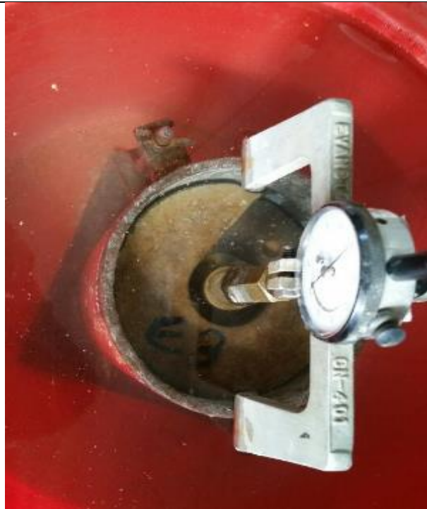
Colocación de deformímetros para medición de esponjamiento
