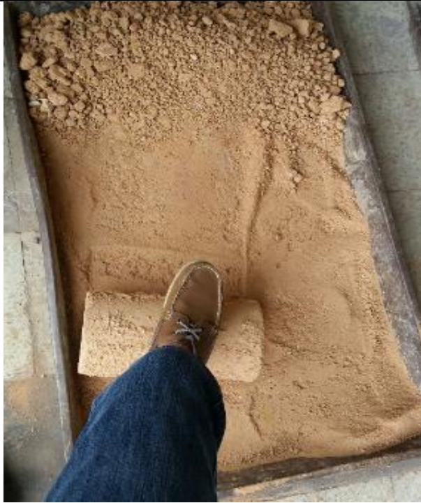
Trituración de suelo con la ayuda de un cilindro de hormigón
