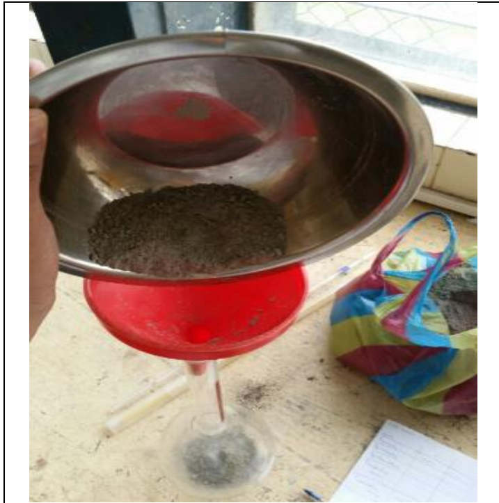
Colocación de Cemento en Picnómetro
