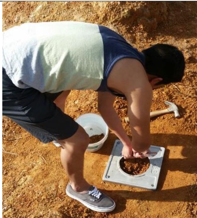
Extracción del suelo demarcado por el agujero de la placa
