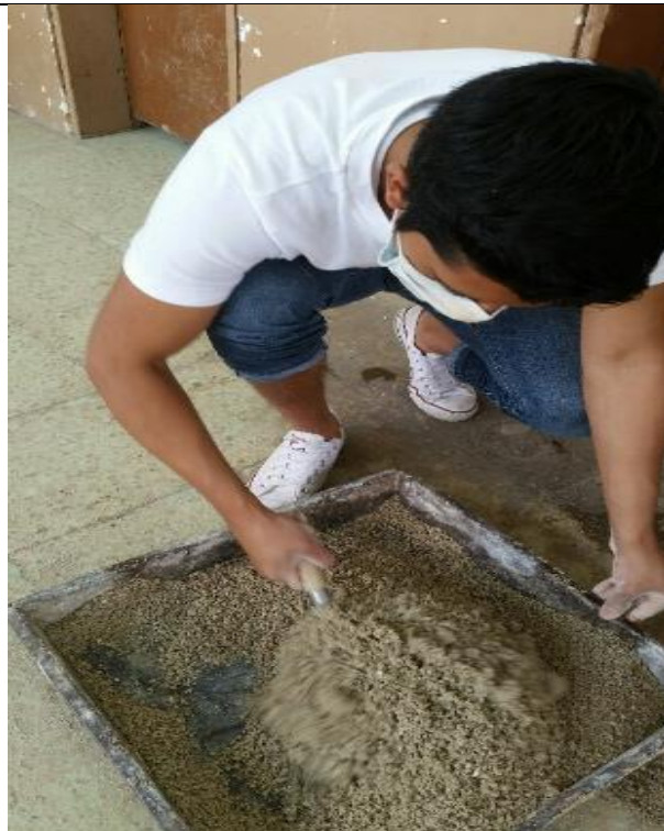
Mezcla del suelo con el contenido de agua óptimo
