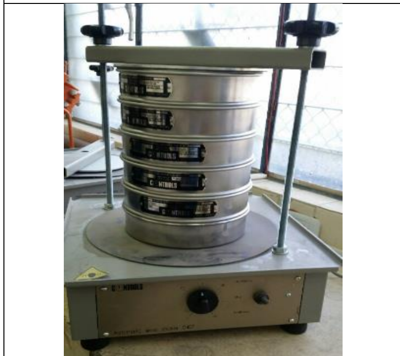
Tamizando el suelo por 15 mins. en tamizadora
