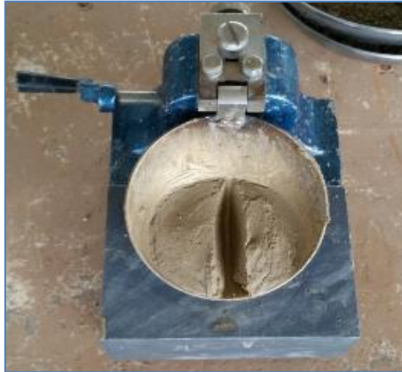
Figura N° 12. Ensayo de la Copa de Cassagrande
