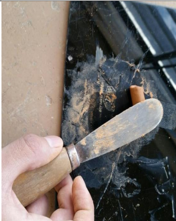
Realizando rollitos de suelo para determinar Límite Plástico
