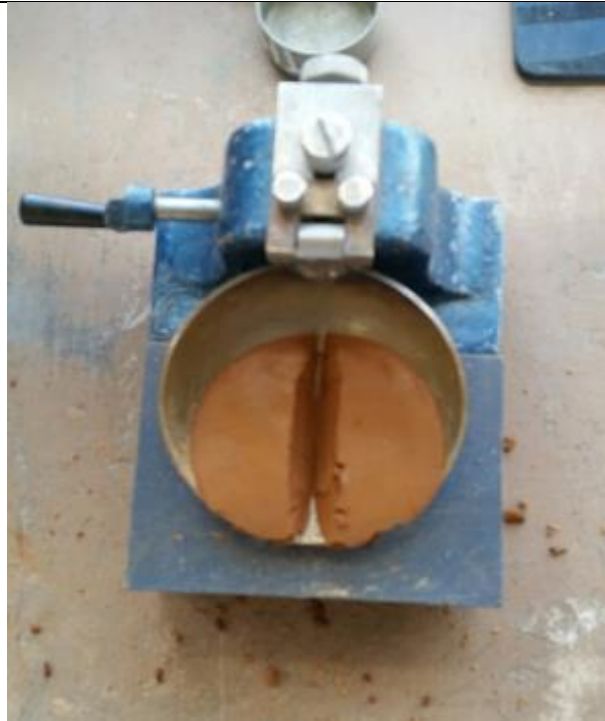
División de suelo para ejecutar los golpes en la copa de Cassagrande
