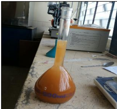
Figura N° 10. Ensayo para determinar la Gravedad Específica de la Muestra #1
