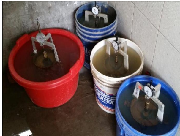
Figura N° 16. Cilindros sumergidos en agua para determinar esponjamiento
