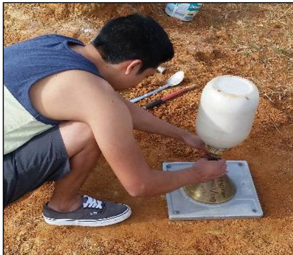
Figura N° 8. Ensayo de Cono y Arena de Ottawa
