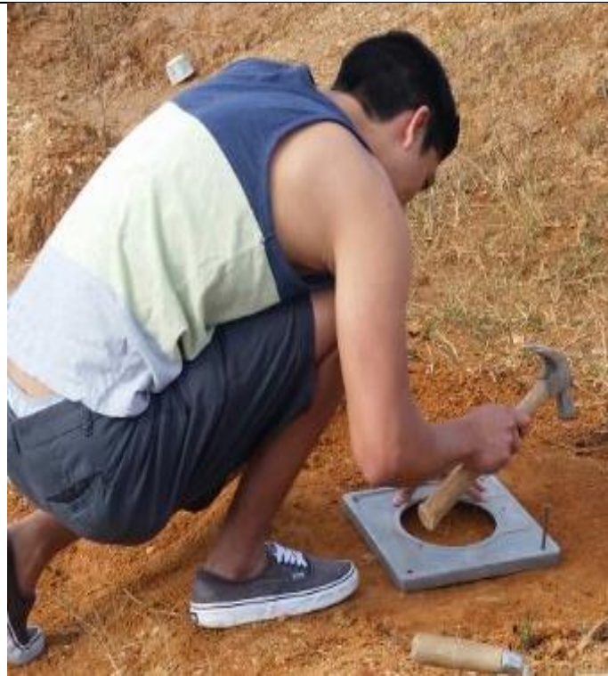
Colocación de placa en el sitio limpiado
