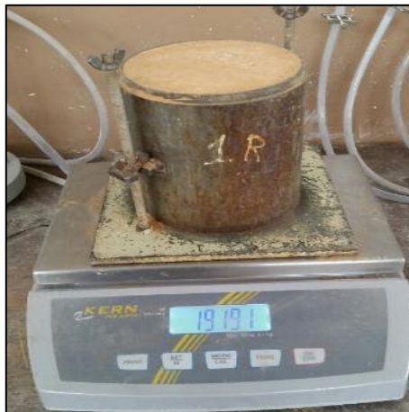
Figura N° 15. Pesaje de cilindro con el suelo compactado
