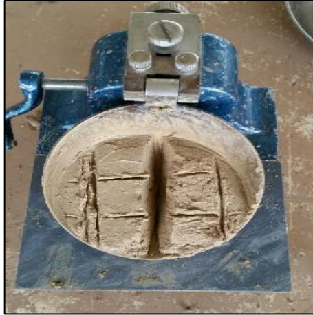
Figura N° 13. División en cuadrantes/Determinación de Límite Líquido
