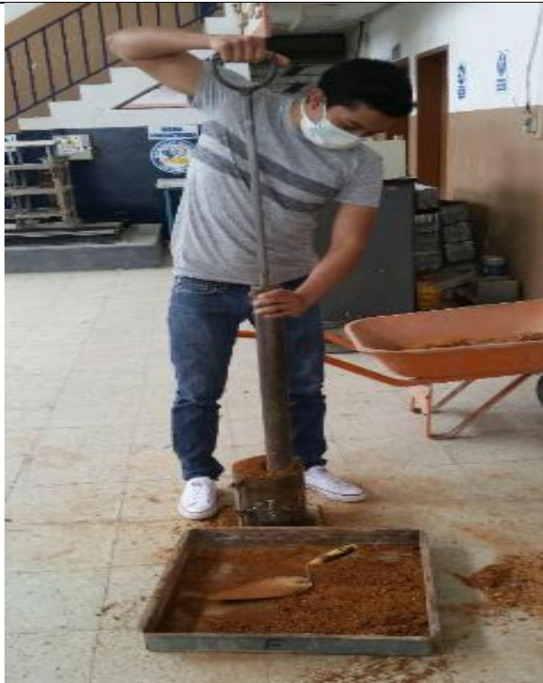
Ejecución de golpes con martillo de compactación
