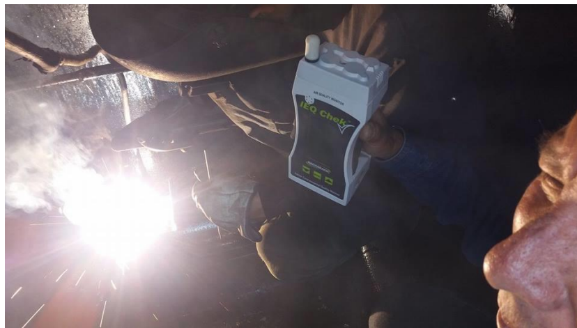
Figura No. 27. Medición de gases en el Interior del Autotanque. Fuente: Empresa.
