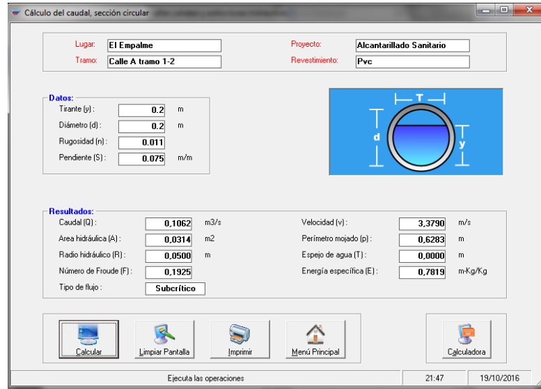
Gráfico N° 12. Cálculo de la sección a tubo totalmente lleno
