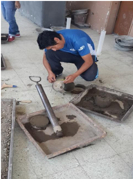
Ensayo de Proctor
