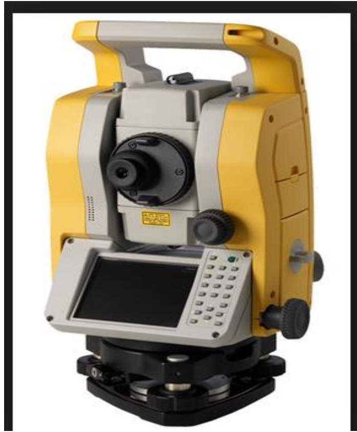
Gráfico N° 13. Estación total Tremble M3.
