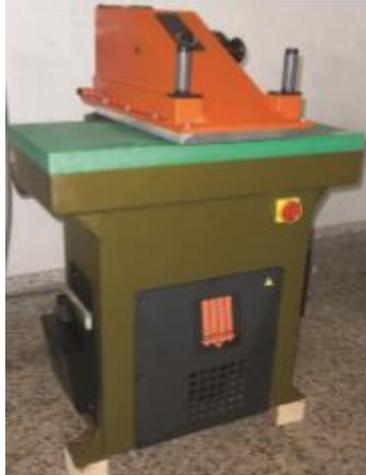
**Figura 6. 4** Troqueladora oleo-hidráulico, marca ATOM (Procedencia China)
