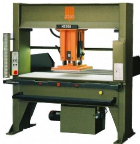
**Figura 2.11** Troqueladora de puente tipo ATOM
