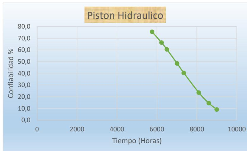
**Figura 6.69:** Curva de Weibull del pistón oleo-hidráulico
