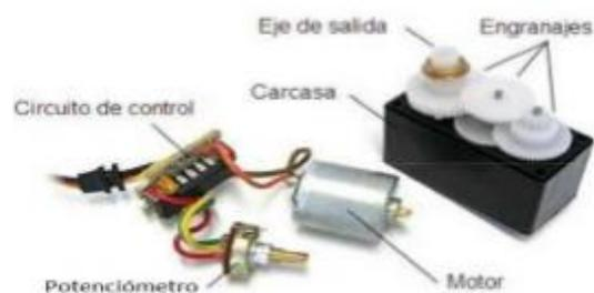
**Figura 2.3** Elementos de un Servomotor eléctrico
