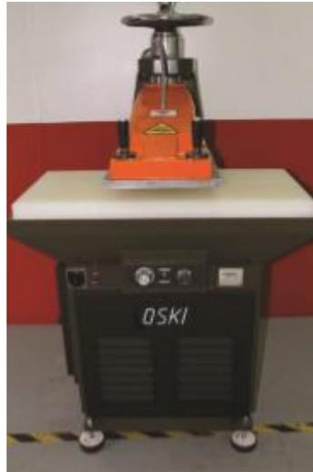
**Figura 2.13** Troqueladora oleo-hidráulica OSKI
