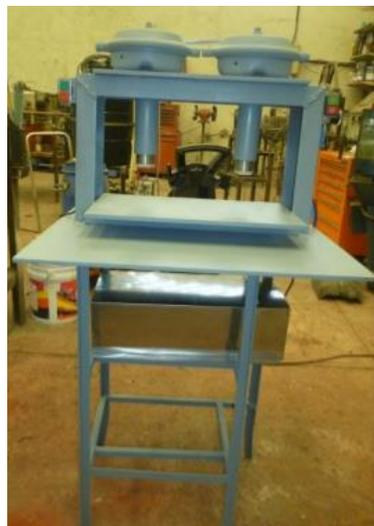
**Figura 6. 3** Máquina de troquelado neumático
