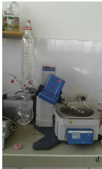
Figura 4. Obtención de los extractos etanólicos de hoja y semilla de chirimoya
