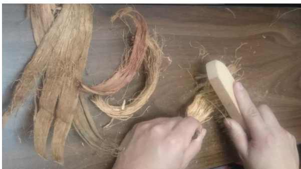
Figura 3.7.- Eliminación de material fenólico con cepillo de alambre Fuete: Autor
