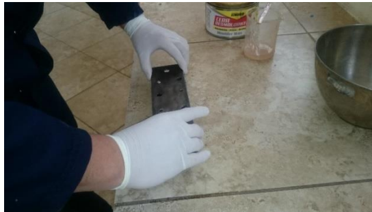
Figura 3.33.- Colocación de la tapa de la matriz Fuente: Autor
