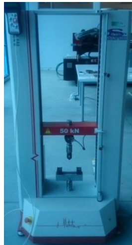
Figura 2.18.- Máquina Universal MTE-50 para flexión Fuente: Autor
