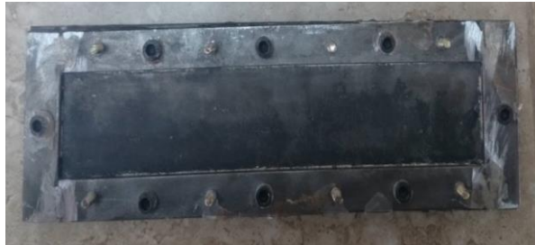
Figura 3.21.- Molde de impacto según norma ASTM D5628 Fuente: Autor
