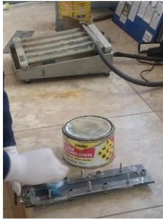
Figura 3.27.- Aplicación de cera desmoldante Fuente. Autor
