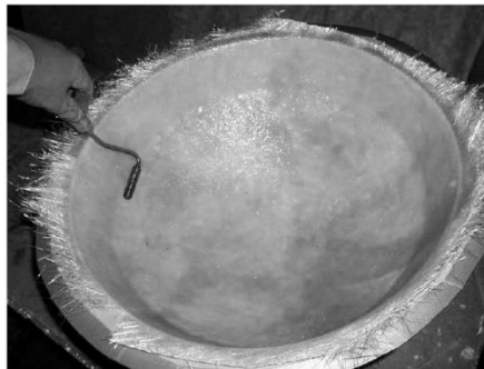
Figura 2.15.- Fabricación por estratificación manual [11]
