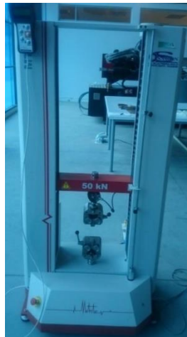
Figura 2.16.- Máquina universal MTE-50 para tracción Fuente: Autor
