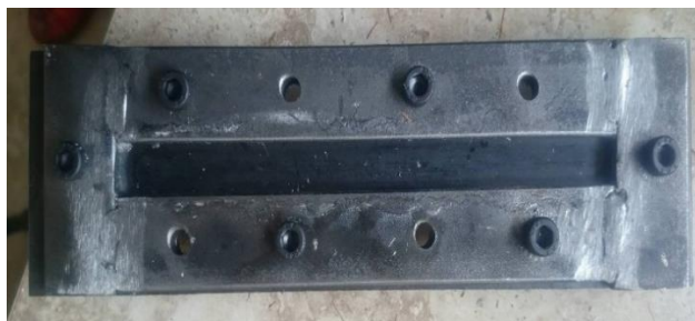
Figura 3.20.- Molde de flexión según norma ASTM D7264
