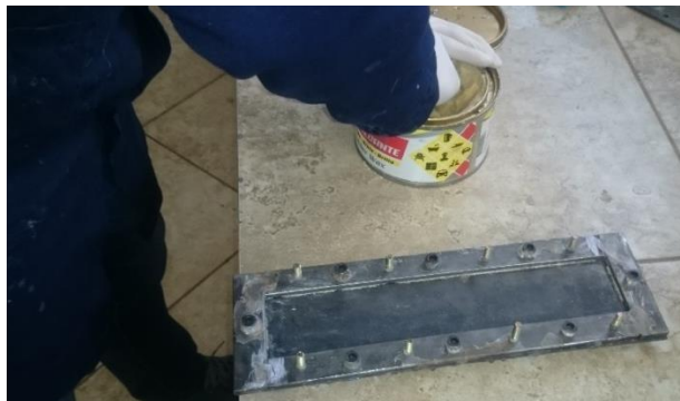
Figura 3.49.- Aplicación de cera desmoldante en el molde de impacto
