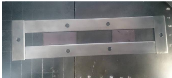
Figura 3.19- Molde de tracción según norma ASTM D-3039
