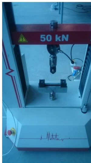
Figura 3.48.- Máquina universal MTE-50 accesorios de flexión Fuente: Autor
