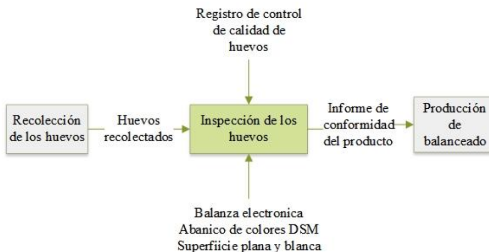
Fig. 33. Entradas y salidas del proceso de inspección de los huevos.
