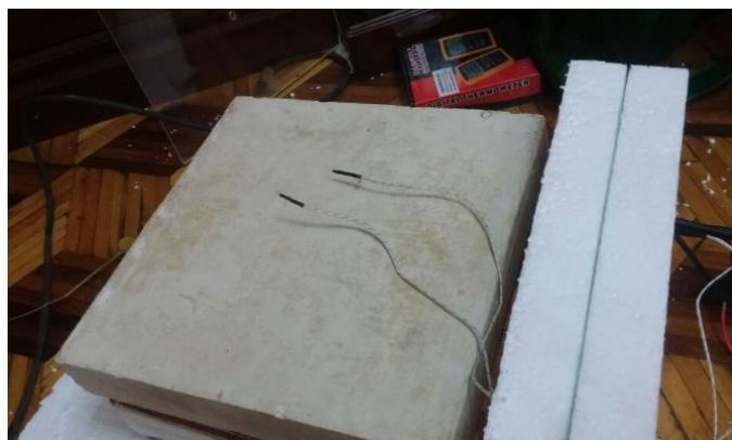
Figura 20. Sensores en contacto con la placa fría.
