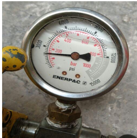
Figura 14. Presión de trabajo para el compactado.
