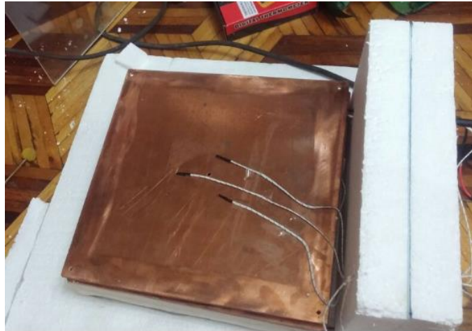
Figura 19. Sensores térmicos colocados en la placa caliente.
