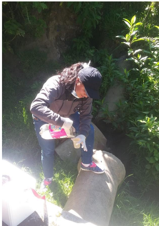
Foto N° 2.- Toma de muestra inicial entrada a la planta de tratamiento de Papahurco.
