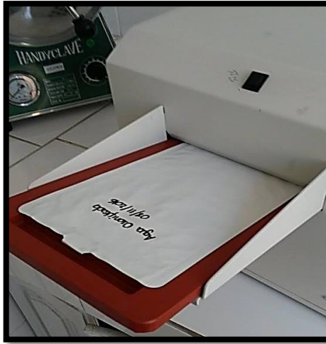
Ilustración G-4 Muestra de agua envasada sellada en el equipo QUANTI-TRAY SEALER (NMP)
