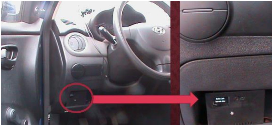
Figura 4.33 Sistema de Rastreo Instalado en Automóvil
