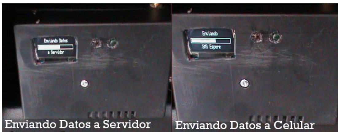
Figura 4.38 Envío de Datos a Servidor y Celular
