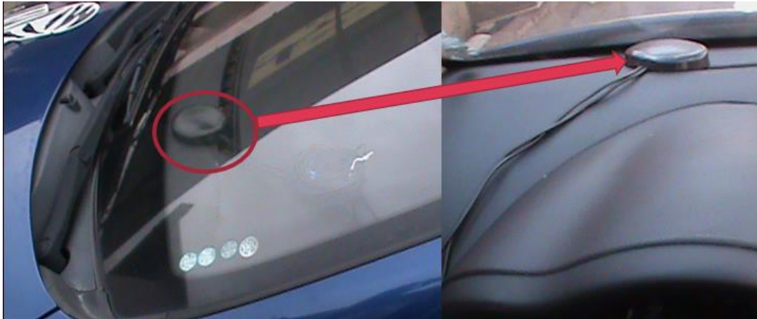
Figura 4.34 Antena GPS ubicada en Automóvil
