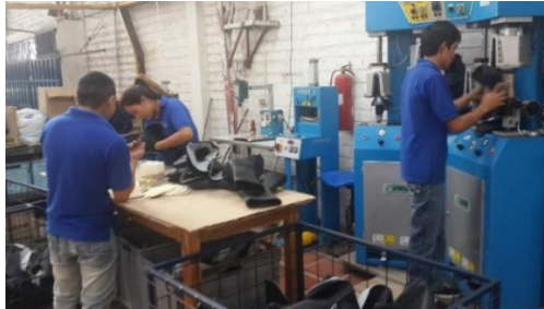
Figura 57 Conformado de Punta y Talón. Fuente: Empresa MARCIA “Buffalo Industrial”
