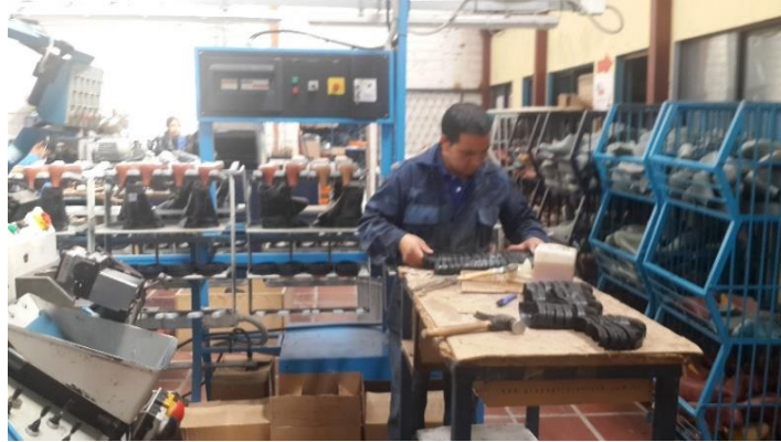
Figura 61 Armado de puntas Fuente: Empresa MARCIA “Buffalo Industrial”
