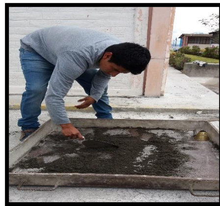
Fotografía 16.- Secado del agregado fino hasta el estado saturado superficie seca.
