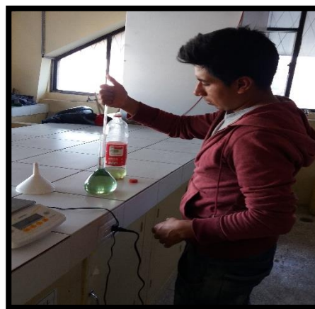
Fotografía 26.- Llenado de la gasolina en el picnómetro hasta el aforo.
