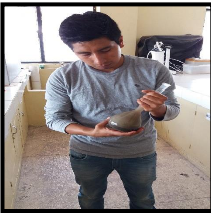
Fotografía 21.- Mezclado de la arena en estado saturado superficie seca con el agua.
