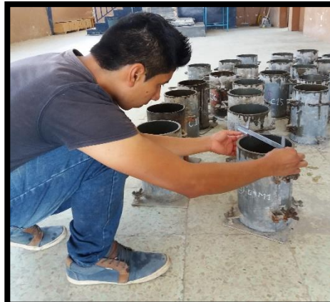
Fotografía 40.- Medición del diámetro de los cilindros para las probetas de hormigón.
