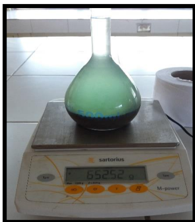
Fotografía 25.- Peso del picnómetro añadido cemento y gasolina hasta el aforo.
