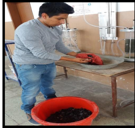
Fotografía 18.- Secado del agregado grueso hasta el estado saturado superficie seca.
