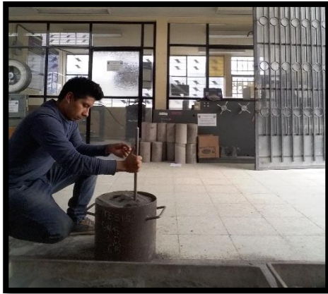
Fotografía 11.- Densidad aparente compactada del agregado fino.
