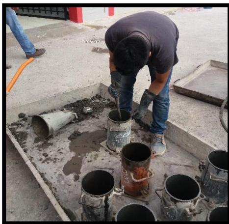
Fotografía 43.- Elaboración de las probetas de hormigón con ceniza de cáscara de trigo.
