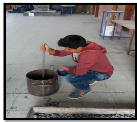
Fotografía 8.- Densidad aparente compactada del agregado grueso.
