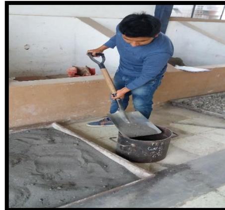
Fotografía 10.- Densidad aparente suelta del agregado fino.
