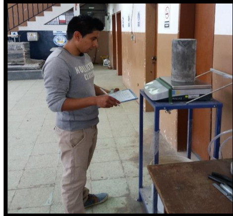
Fotografía 54.- Peso de las probetas de hormigón a ser ensayadas.
