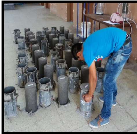
Fotografía 51.- Desencofrado de las probetas de hormigón.
