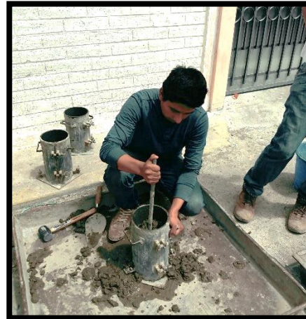
Fotografía 30.- Elaboración de las probetas de hormigón f´c = 240 kg/cm2.
