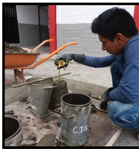
Fotografía 48.- Chequeo de asentamiento del hormigón con adición de microsilice.
