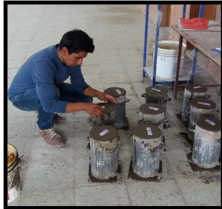
Fotografía 32.- Colocación de etiquetas en las probetas de hormigón f'c = 240 \text{ kg/cm}^2 .
