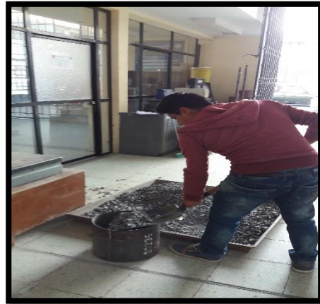
Fotografía 7.- Densidad aparente suelta del agregado grueso.
