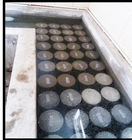
Fotografía 52.- Colocación de las probetas de hormigón en la cámara de curado.
