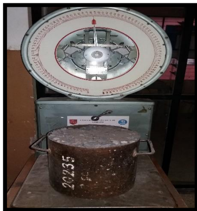
Fotografía 15.- Peso de la muestra con la mezcla de los agregados compactados.
