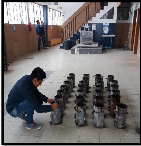
Fotografía 45.- Medición del diámetro de los cilindros para las probetas de hormigón.
