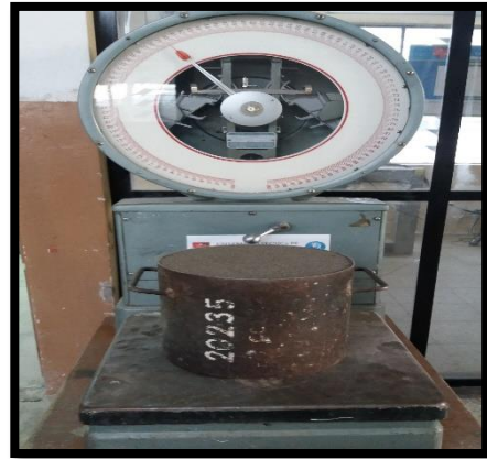
Fotografía 12.- Peso de la muestra con agregado fino compactado.
