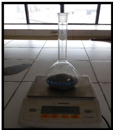
Fotografía 23.- Peso del picnómetro añadido cemento.
