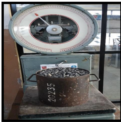
Fotografía 9.- Peso de la muestra con agregado grueso compactado.
