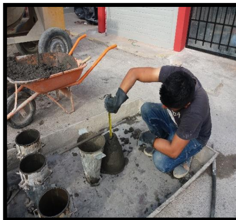
Fotografía 42.- Chequeo del asentamiento con el cono de Abrams.
