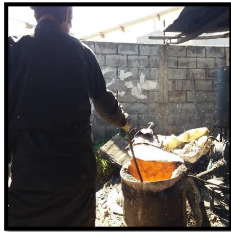
Fotografía 34.- Quemado de la cáscara de trigo en un horno.
