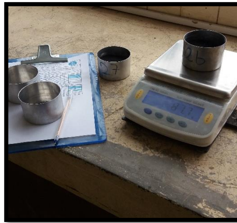
Fotografía 38.- Pesos de las muestras de ceniza de cáscara de trigo en estado S.S.S.
