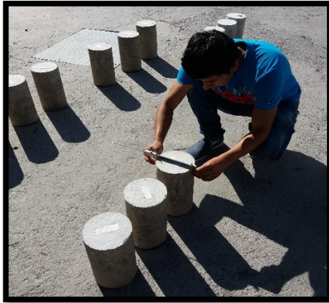
Fotografía 53.- Medición del diámetro de las probetas de hormigón a ser ensayadas.
