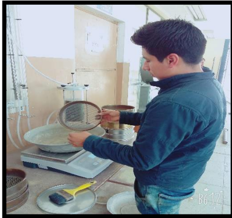
Fotografía 5.- Peso retenido en cada tamiz del agregado fino.
