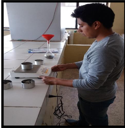
Fotografía 19.- Peso de las muestras de los agregados en estado saturado superficie seca.
