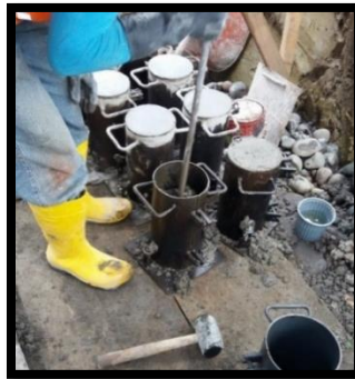
Imagen 3.- Toma de muestras de hormigón en cilindros.
