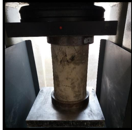
Fotografía 56.- Ensayo de las probetas de hormigón en la máquina de compresión.
