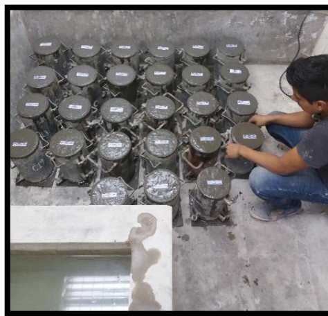
Fotografía 44.- Colocación de etiquetas en las probetas de hormigón con ceniza.
