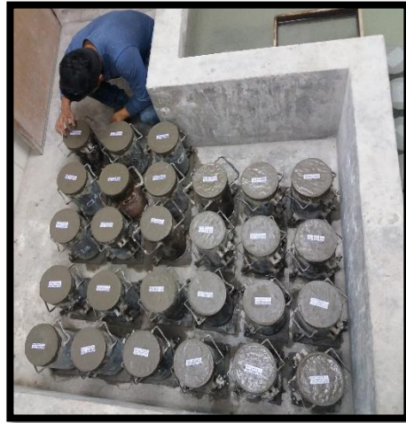
Fotografía 50.- Colocación de etiquetas en las probetas de hormigón con microsíllice.
