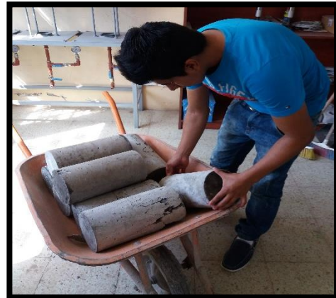
Fotografía 58.- Desalajo de las probetas de hormigón ensayadas.
