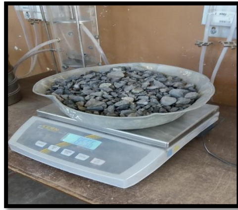
Fotografía 6.- Peso retenido en cada tamiz del agregado grueso.
