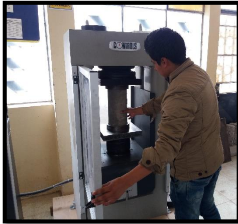
Fotografía 55.- Colocación de las probetas de hormigón en la máquina de compresión.
