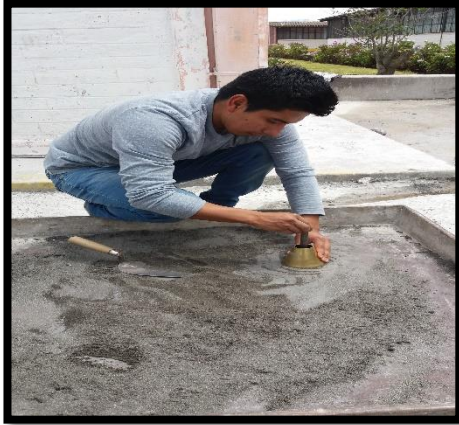
Fotografía 17.- Ensayo para determinar el estado saturado superficie seca.
