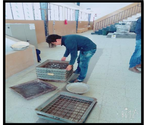
Fotografía 4.- Tamizado del agregado grueso.
