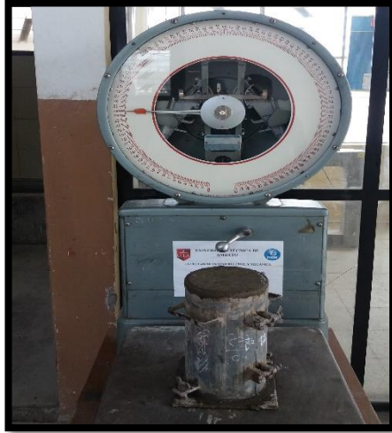
Fotografía 49.- Peso del cilindro más muestra de hormigón con microsíllice.
