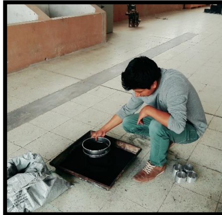
Fotografía 36.- Cernido de la ceniza de cáscara de trigo con el tamiz #200.
