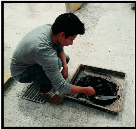
Fotografía 37.- Ceniza de cáscara de trigo en estado saturado superficie seca.
