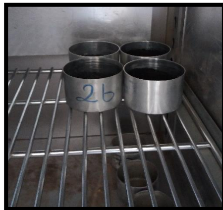
Fotografía 39.- Colocación de las muestras de ceniza de cáscara de trigo S.S.S en el horno
