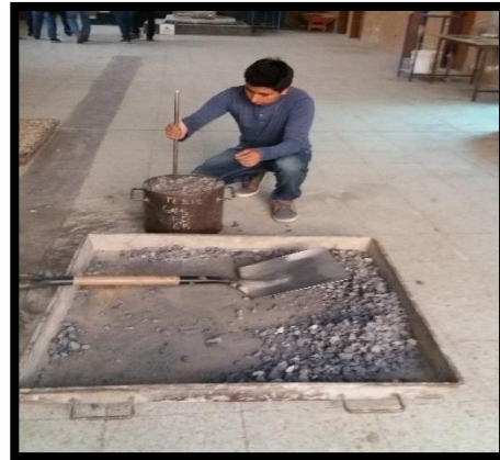
Fotografía 14.- Densidad aparente compactada de la mezcla de agregados.
