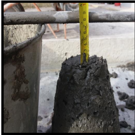
Fotografía 29.- Chequeo del asentamiento del hormigón f´c = 240 kg/cm2.
