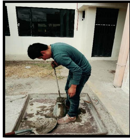
Fotografía 28.- Ensayo del asentamiento con el cono de Abrams.
