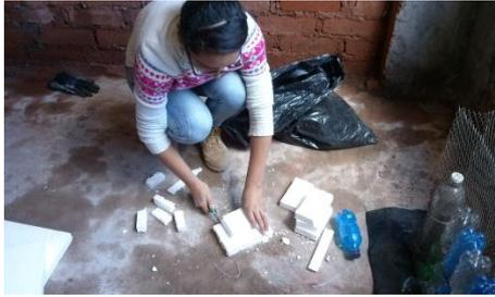
Corte de espuma flex para muestra tipo D
