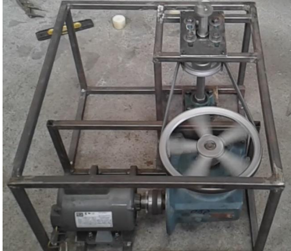
Figura anexo. 33 Prueba de funcionamiento del sistema de transmisión
