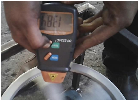
Figura anexo. 34 Comprobación de revoluciones eje motriz (138.4 rpm)
