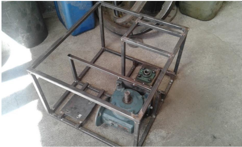
Figura anexo. 31 Estructura completa soldada
