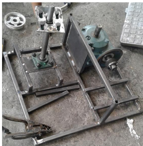
Figura anexo. 29 Soldado de la placa inferior chumacera.
