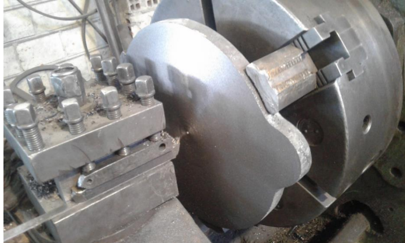
Figura anexo. 30 Torneado de la base porta tamices.
