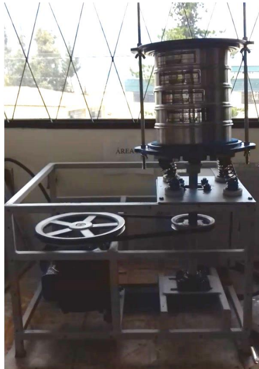
Figura anexo. 37 Pruebas de funcionamiento con la torre de tamices
