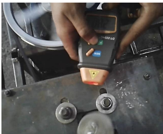
Figura anexo. 35 Comprobación de revoluciones eje conducido (280.1 rpm)
