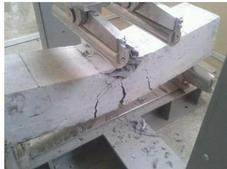
**Fotografía 12.-** Fisuras en el ensayo
