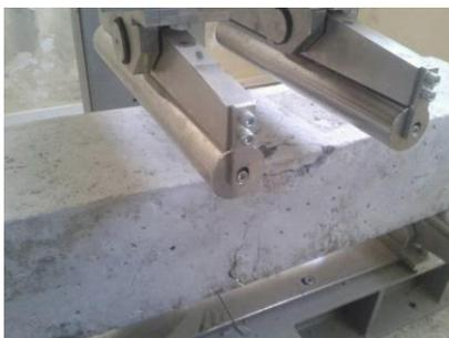
**Fotografía 10.-** Deformación de la Probeta en la Máquina
