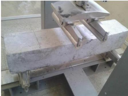
**Fotografía 8.-** Colocación de la Probeta en la Máquina
