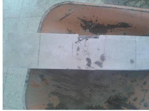
**Fotografía 11.-** Deformación Permanente en Vigas
