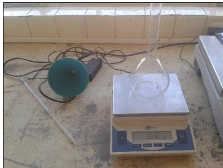
Fotografía N° 12. Peso del Picnómetro
