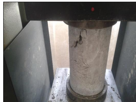
Fotografía N° 36. Falla por fractura en el extremo superior
