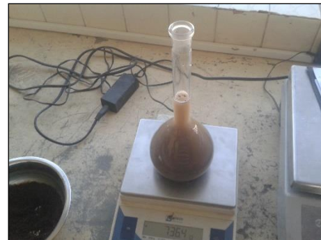
Fotografía N° 13 Picnómetro más Agregado fino
