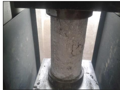
Fotografía N° 34. Falla por Fractura Vertical
