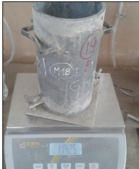
Fotografía N° 15 Peso del molde de Hormigón
