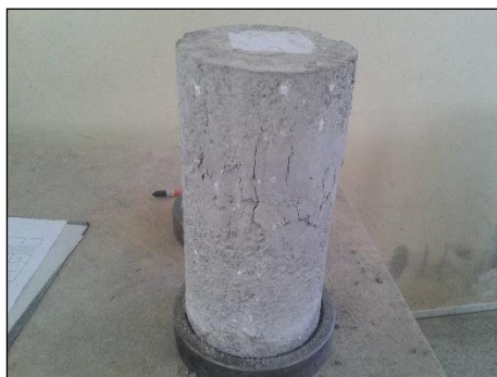
Fotografía N° 23 Resistencia y Falla del cilindro
