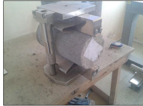
Fotografía N° 26. Colocación del Cilindro para el ensayo a tracción
