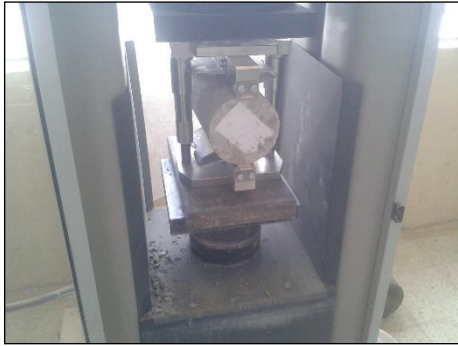
Fotografía N° 25 Tracción del Cilindro
