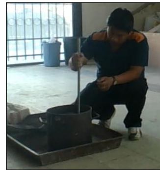
Fotografía N° 11 Compactación del Agregado Fino
