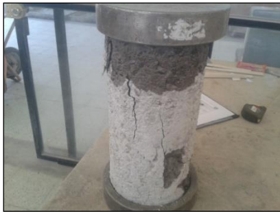
Fotografía N° 33. Falla tipo 2 Fisuras verticales
