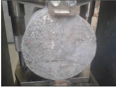
Fotografía N° 31. Falla a tracción normal Fotografía N° 32. Falla a tracción normal
