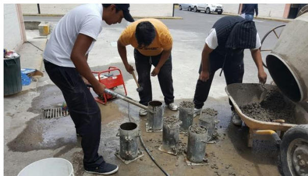
Fotografía N° 18. Colocación del Hormigón en los Moldes
