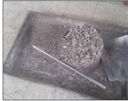
Fotografía N° 9 Compactación del Agregado Grueso
