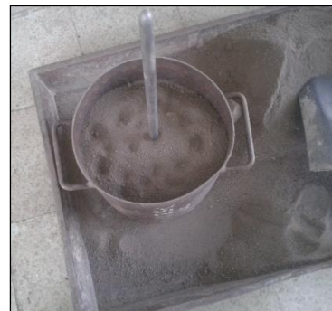
Fotografía N° 7 Compactación del Agregado Fino.
