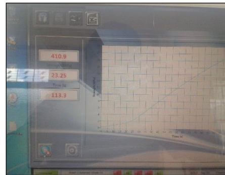
Fotografía N° 22. Resistencia del Cilindro
