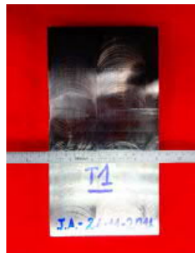
Placa de soldadura de recuperación T1 "Como Soldada" Inspección final. No hay presencia de discontinuidades. Aceptado. Nivel de calidad 1.
