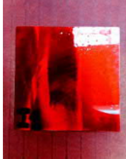
Placa de soldadura de recuperación II "Como Soldada" Inspección final. Aplicación de Penetrante Magnaflux SKL-SP2.
