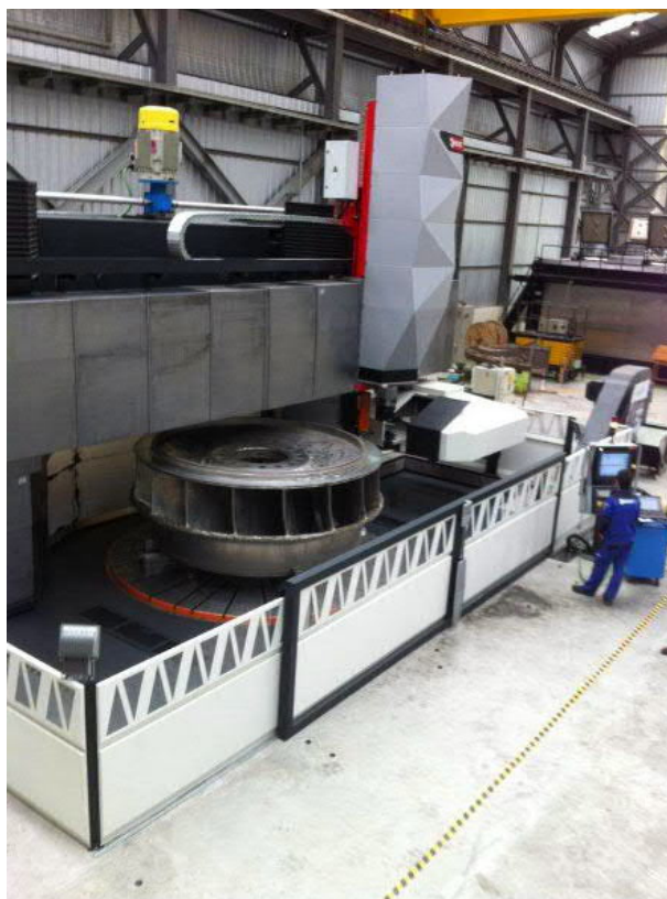
Ilustración 6.6 Mecanizado sobre medida, corona zona exterior.
