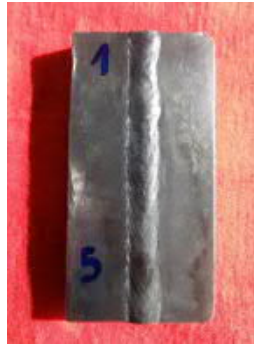
Placa de soldadura de recuperación II "Como Soldada" Inspección de proceso en la condición soldada.
