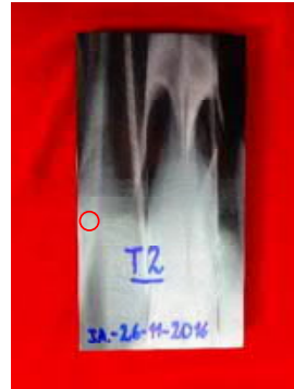
Placa T2 "Revenido a 600 °C x 1 hora, 1ra recuperación". Vista de mecanizado final. 1 Indicación redondeada (porosidad) en la zona de descarte.
