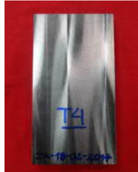
Placa T4 "Revenido a 600 °C x 1 hora, 3ra recuperación" Vista de mecanizado final. 5 Indicaciones redondeadas (porosidad) en la zona de depósito de soldadura.
