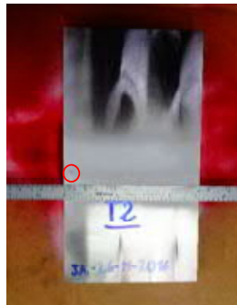
Placa T2 "Revenido a 600 °C x 1 hora, 1ra recuperación" 1 Indicación redondeada de \varnothing=1.5 mm en la zona de descarte, x=-14 , y=7 mm.
