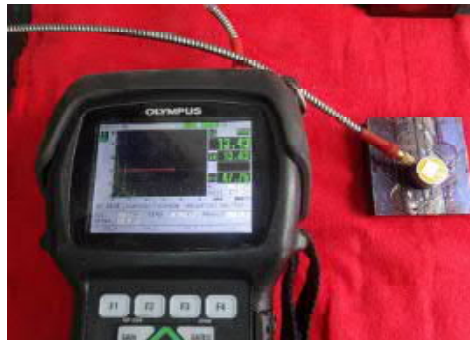
Placa de soldadura T7 "Revenido a 600 °C x 2 horas, 3ra recuperación" Ultrasonido, haz recto. No hay presencia de discontinuidades relevantes.
