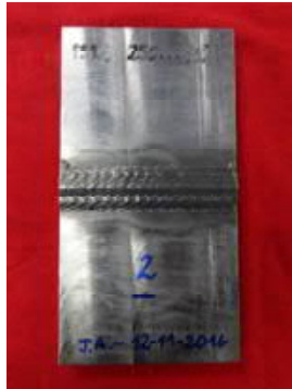
Placa de soldadura de recuperación T2 Inspección de proceso en la condición soldada.
