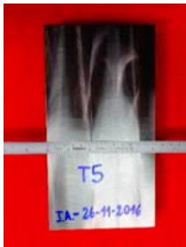
Placa T5 "Revenido a 600 °C x 2 horas, 1ra recuperación". Inspección final. 1 Indicación redondeada L=0,5 mm, x=-4, y=54 mm. Aceptado Nivel de calidad 1.
