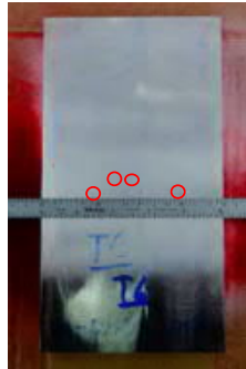
Placa T6 "Revenido a 600 °C x 2 horas, 2da recuperación" 2 Indicaciones redondeadas \varnothing_{max}=1 mm, x=-4, y=54; x=-9, y=97.5 mm. 1 Indicación lineal a=0.5 mm.
