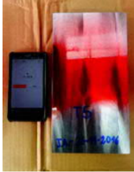
Placa de soldadura de recuperación T5 Aplicación de Penetrante Magnaflux SKL-SP2.
