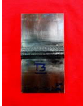
Placa de soldadura de recuperación T3 Inspección de proceso en la condición soldada.
