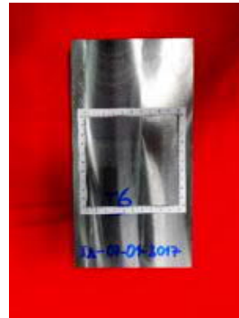
Placa T6 "Revenido a 600 °C x 2 horas, 2da recuperación". Inspección final. 1 Indicación redondeada, H=0,5 mm. Área de discontinuidades 0,79 mm 2 . Aceptado. Nivel de calidad 2.
