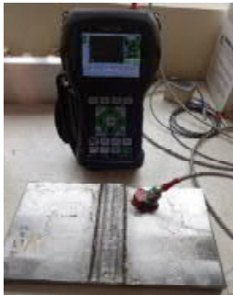
Placa de soldadura de recuperación T1 "Como Soldada" Inspección por Ultrasonido, haz angular.
