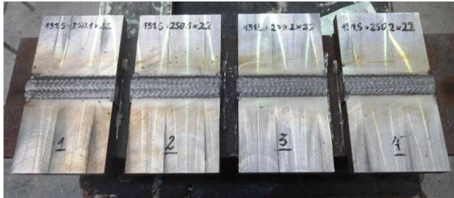
Ilustración 4.7 Placas soldadas ASTM A743 CA6-NM de 250x130x22 mm.
