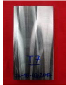
Placa T7 "Revenido a 600 °C x 2 horas, 3ra recuperación" Vista de mecanizado final. 6 Indicaciones redondeadas (porosidad) en la zona de depósito de soldadura.
