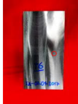
Placa de soldadura T6 "Revenido a 600 °C x 2 horas, 2da recuperación". Vista de mecanizado final. 1 Indicación redondeada (porosidad) en la zona de depósito de soldadura.
