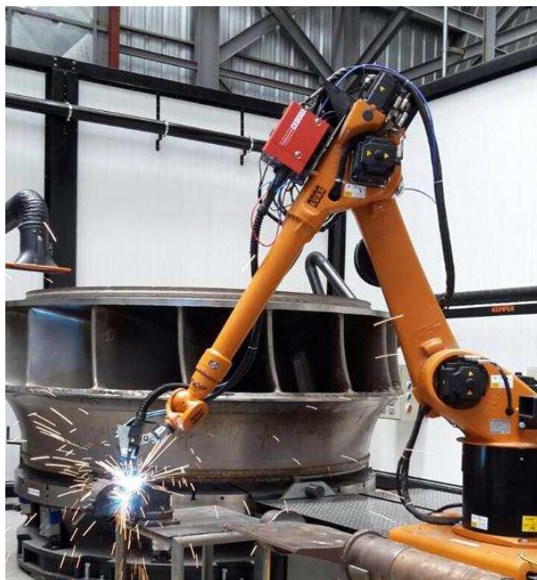
Ilustración 6.5 Soldadura GMAW, laberinto inferior.
