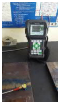
Placa de soldadura T3 "Revenido a 600 °C x 1 hora, 2da recuperación". Inspección por Ultrasonido, haz recto. No hay presencia de discontinuidades relevantes.
