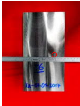
Placa T6 "Revenido a 600 °C x 2 horas, 2da recuperación". Inspección final. 1 Indicación redondeada L=1 mm, x=-9, y=97,5 mm. Aceptado Nivel de calidad 2.
