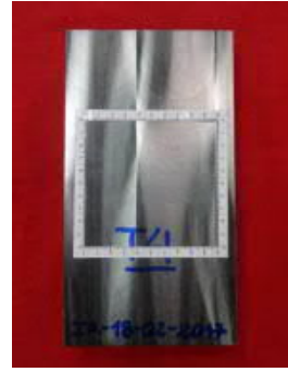
Placa de soldadura T4 "Revenido a 600 °C x 1 hora, 3ra recuperación". 5 Indicaciones redondeadas, Área total de discontinuidades 1 mm 2 . Aceptado. Nivel de calidad I.
