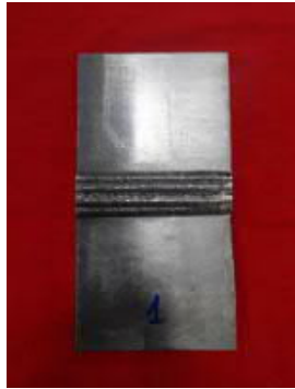
Placa de soldadura de recuperación T1 "Como Soldada" Inspección de proceso en la condición soldada.
