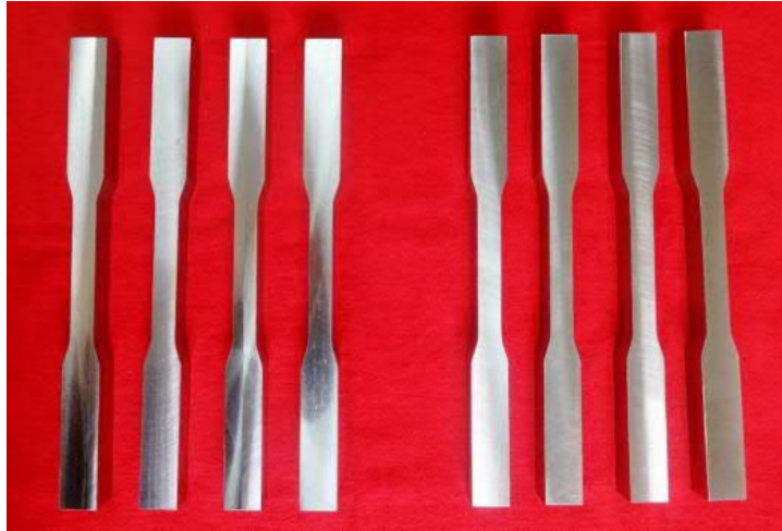
Ilustración 4.9 Probetas de tracción de 250 x 20 mm. espesor 19 mm.
