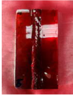
Placa de soldadura de recuperación II "Como Soldada" Aplicación de Penetrante Magnaflux SKL-SP2. Inspección de proceso en la condición soldada.
