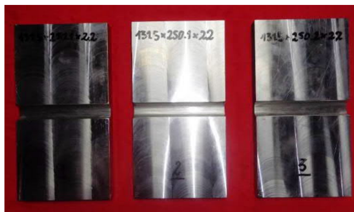
Ilustración 4.3 Placas de soldadura de 250x130x22 mm. con ranura central de 20x8 mm. sección en U.
