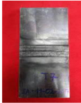
Placa de soldadura de recuperación T7 Inspección de proceso en la condición soldada.
