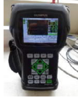
Placa de soldadura de recuperación T1 "Como Soldada" Inspección por Ultrasonido, haz angular. No hay presencia de discontinuidades relevantes.
