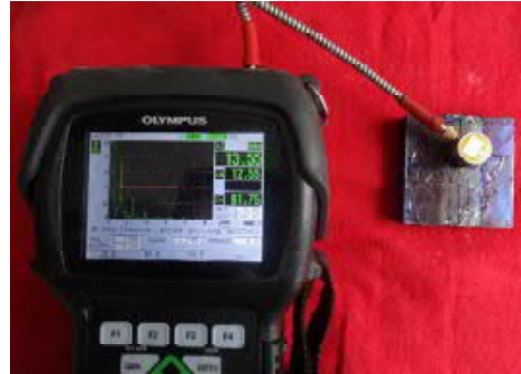
Placa T6 "Revenido a 600 °C x 2 horas, 2da recuperación" Ultrasonido, haz recto. No hay presencia de discontinuidades relevantes.
