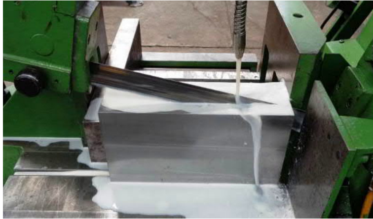
Ilustración 4.1 Preparación de material base acero ASTM A743 CA6-NM.
