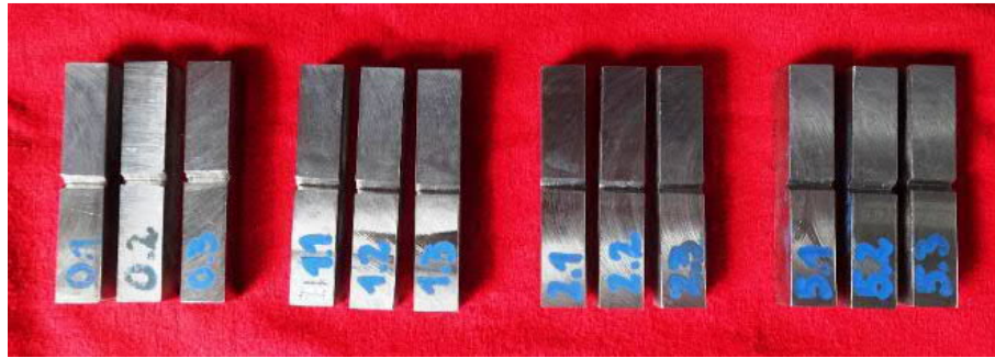
Ilustración 4.10 Probetas de impacto Charpy tipo A de 10x10x55 mm.
