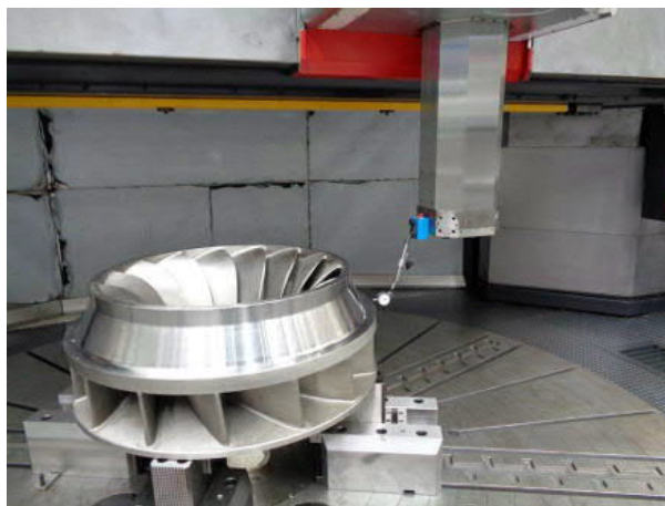
Ilustración 6.7 Control final, mediciones en la banda zona de entrada.
