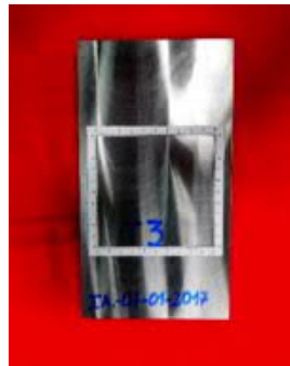
Placa T3 "Revenido a 600 °C x 1 hora, 2da recuperación". 5 Indicaciones redondeadas, Área total de discontinuidades 2.75 mm 2 . Aceptado. Nivel de calidad 2.
