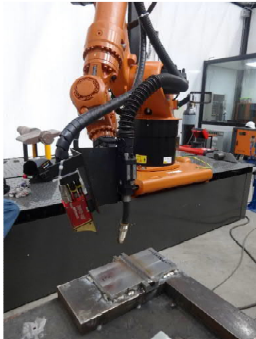
Ilustración 4.4 Proceso de soldadura GMAW robotizada.
