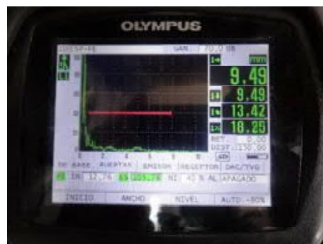
Placa de soldadura T7 "Revenido a 600 °C x 2 horas, 3ra recuperación". Inspección por Ultrasonido, haz angular. No hay presencia de discontinuidades relevantes.
