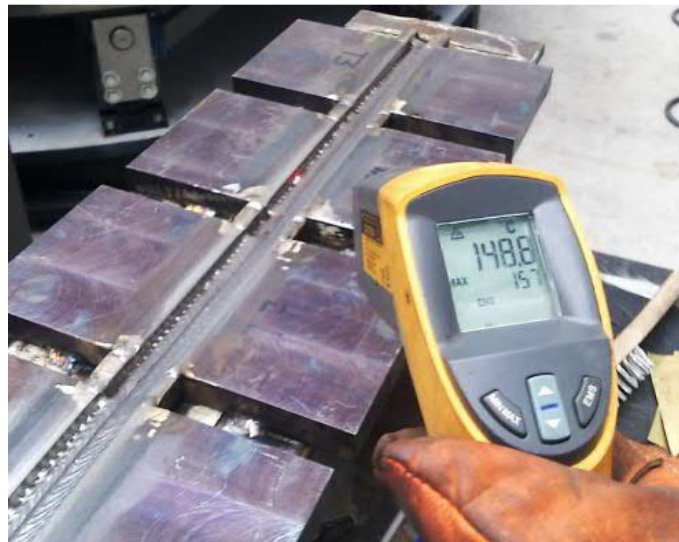
Ilustración 4.5 Control de la temperatura de interfase.
