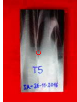
Placa de soldadura T5 "Revenido a 600 °C x 2 horas, 1ra recuperación". Vista de mecanizado final. 1 Indicación redondeada (porosidad) en la zona de depósito de soldadura.
