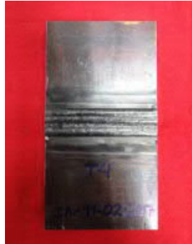
Placa de soldadura de recuperación T4 Inspección de proceso en la condición soldada.
