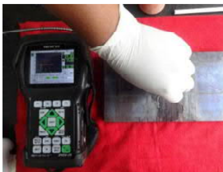
Placa de soldadura T4 "Revenido a 600 °C x 1 hora, 3ra recuperación". Inspección por Ultrasonido, haz recto. No hay presencia de discontinuidades relevantes.
