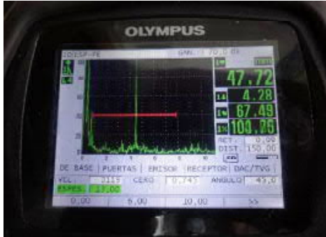
Placa T3 "Revenido a 600 °C x 1 hora, 2da recuperación" Ultrasonido, haz angular (verificación del borde). No hay presencia de discontinuidades relevantes.
