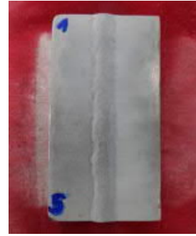
Placa de soldadura de recuperación II "Como Soldada" Aplicación de Revelador Magnaflux SKD-S2. Inspección de proceso en la condición soldada.
