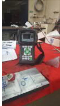
Placa de soldadura T2 "Revenido a 600 °C x 1 hora, 1ra recuperación". Inspección por Ultrasonido, haz angular. No hay presencia de discontinuidades relevantes.
