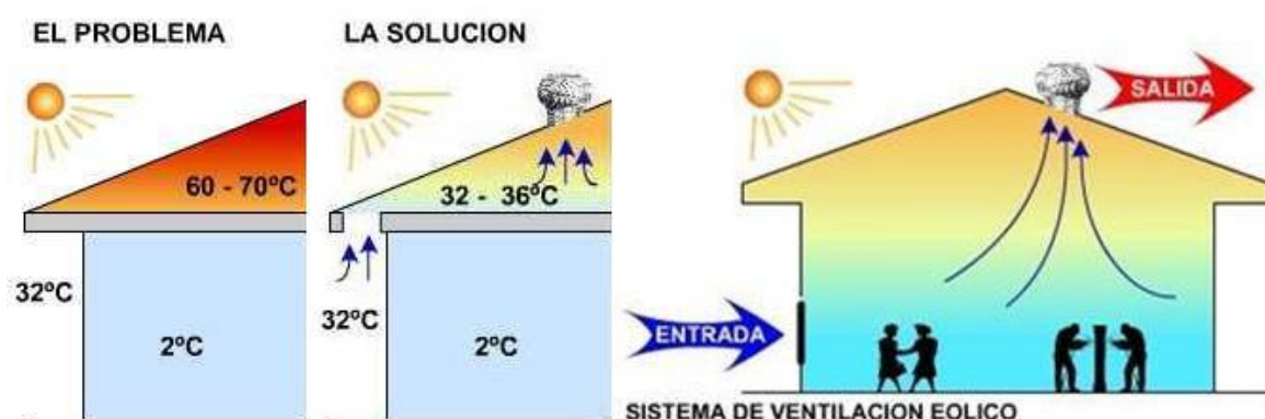
Figura 45: Sistema de ventilación eólico.
