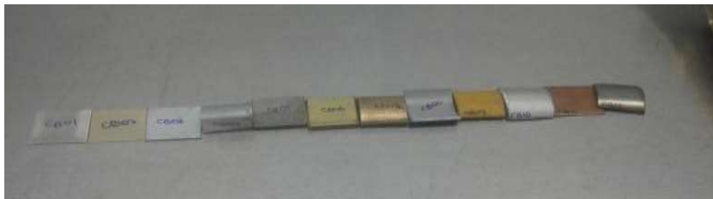
Figura 3.5 Materiales sometidos a contaminación biológica
