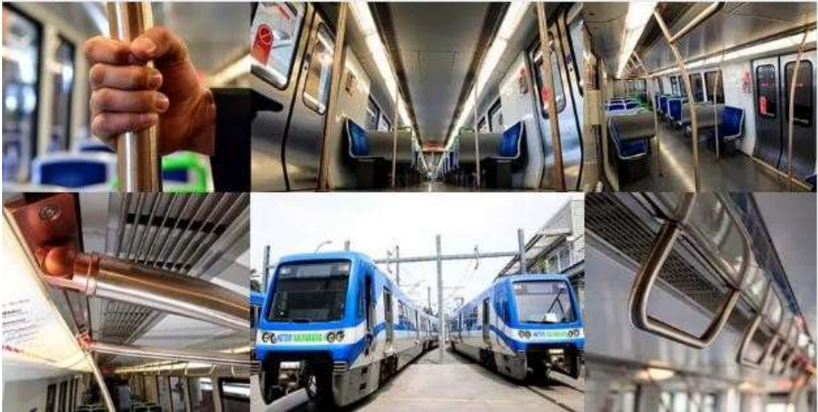
Figura. 2.4 Metro de Valparaíso tiene el primer tren con cobre antimicrobiano en pasamanos [17].
