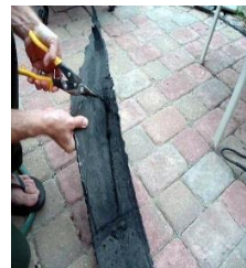
Figura N° 19. Proceso de fabricación de suelas manualmente
