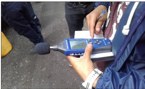
Figura 30. 7 Registro de condiciones ambientales en el lugar de ensayo
