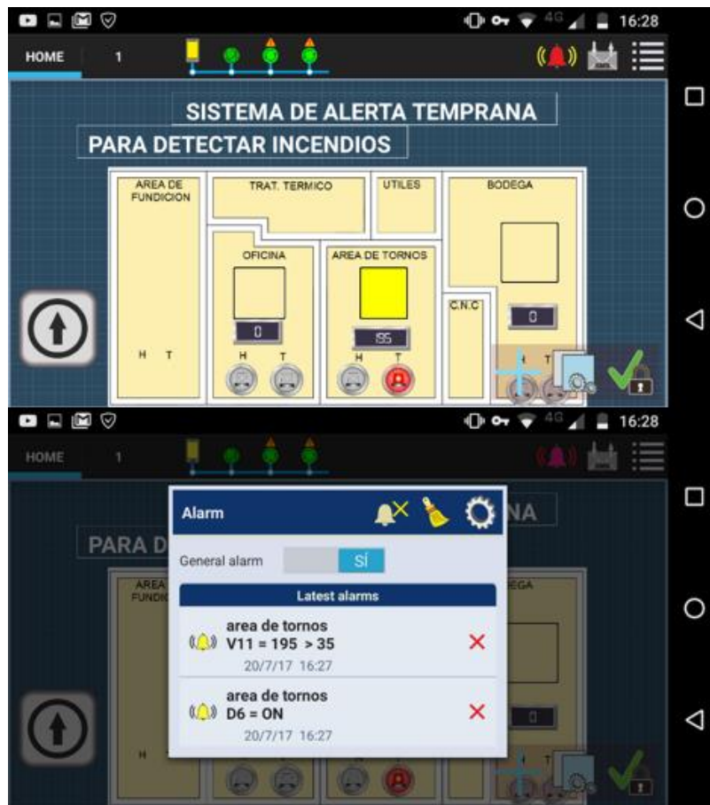
Figura 4. 43: Activación del sistema electrónico de alera temprana para la detección de incendios
