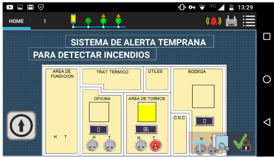
Figura 4. 51: Tercera prueba del día 2 del prototipo del sistema electrónico de alerta temprana para la detección de incendios
