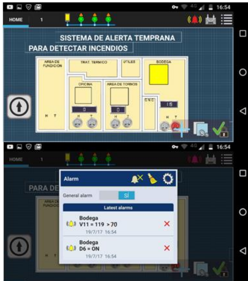
Figura 4. 52: Quinta prueba del día 2 del prototipo del sistema electrónico de alerta temprana para la detección de incendios
