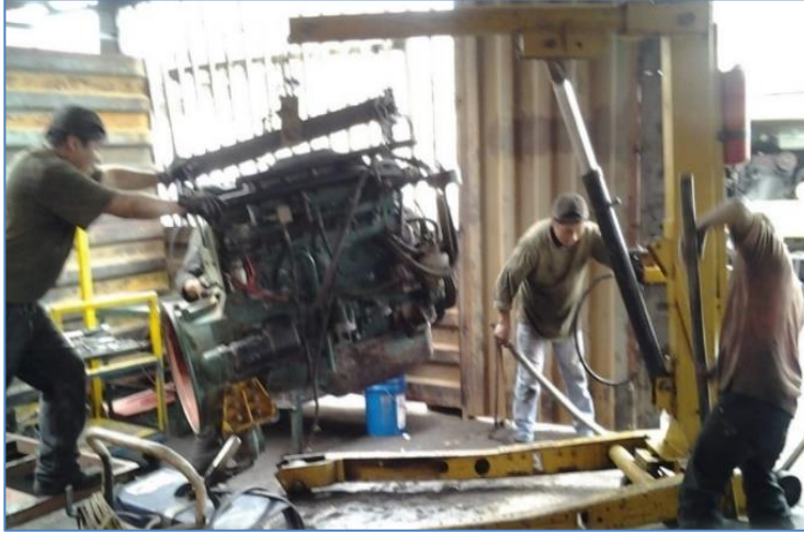
Imagen 7. Transporte Del Motor Armado. Montaje P Método de tablas de Snook y Ciriello. Fuente: Automekano (2015)
