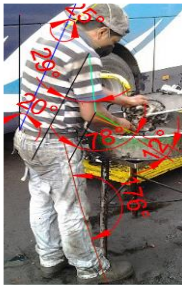
Imagen 5. Limpieza De Las Partes Del Motor Aplicación REBA Elaborado por: el investigador.
