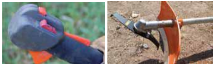
Figura22. Detalle de mando unificado de corte.
