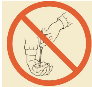
Figura57. Sujeción incorrecta de una pieza a atornillar.
