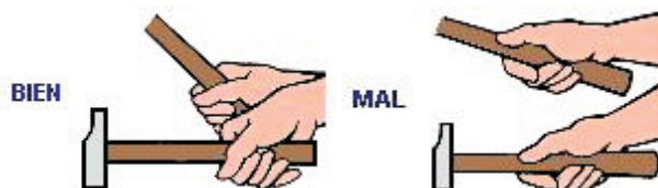
Figura37. Forma de sostenimiento del mango.
