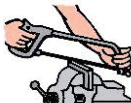
Figura53. Pieza fijada firmemente antes de aserrar.
