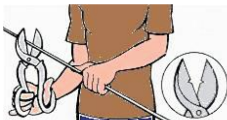
Figura36. Utilización incorrecta de tijeras con hojas dentadas
