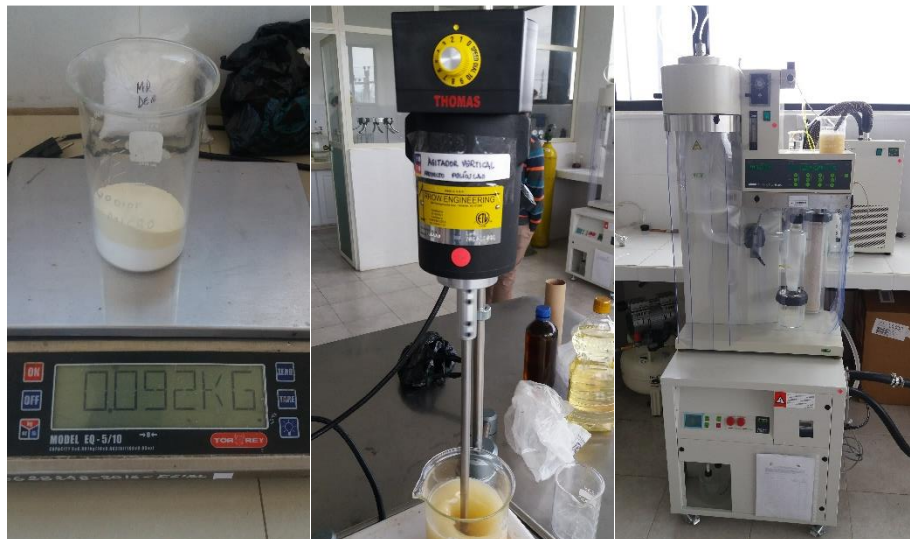
Imagen 2. Preparación de mezcla polimérica con mezcla de aceites y proceso de microencapsulación
