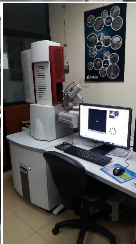
Imagen 7. Muestras recubiertas con oro y observación por microscopía electrónica de barrido
