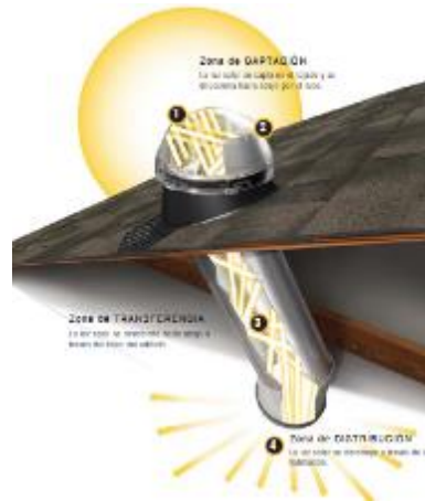
Imagen N° 127: Sistema de iluminación natural Solatube Fuente: (SOLATUBE, 2014)
