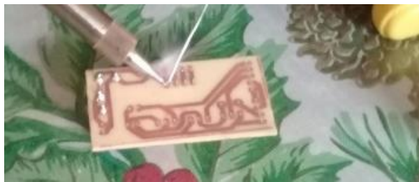
Figura 4.78: Soldadura de los elementos en la placa. Fuente: Investigador
