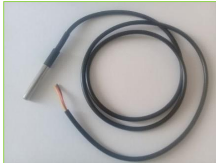
Figura 2.11: Sensor de temperatura del agua. Fuente: Fotografía tomada por el investigador.
