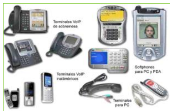
Figura 2.4: Terminales telefónicos de VoIP. Fuente: Carballar José Antonio. “VoIP, La telefonía de Internet”. [20]
