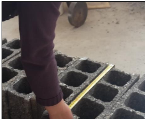
Gráfico 48. Medidas de bloques previas al ensayo
