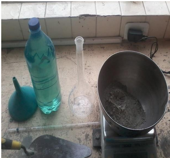
Materiales para densidad real cemento
