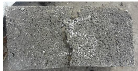
Fisura de bloques con el 5% de poliestireno
