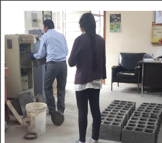
Ensayo de bloques a compresión
