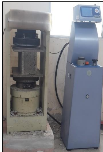
Gráfico 49. Ensayo de compresión de bloques 15x20x40
