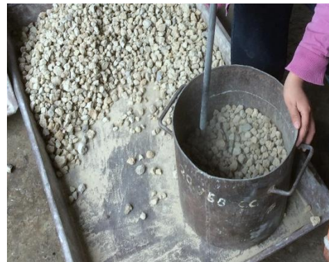
Compactación de la mezcla
