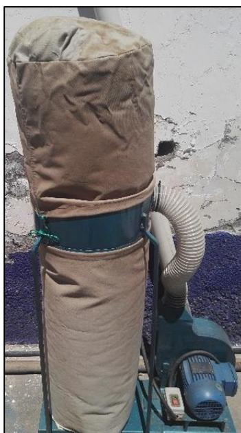
*Figura 55* Recolector de polvo químico desde el extractor centrífugo. Elaborado por investigador.
