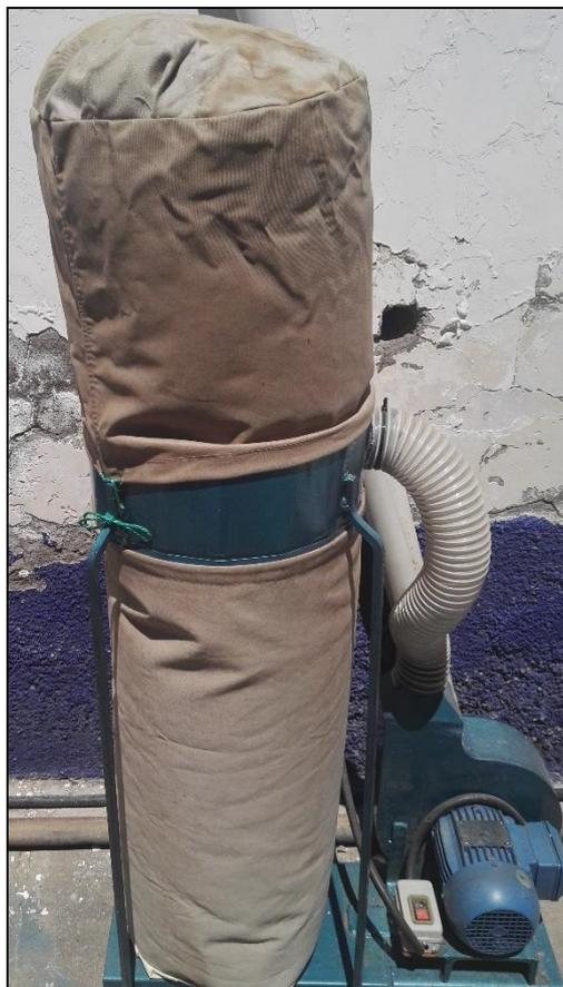
**Figura 3.-** Sistema de extracción y almacenamiento de polvo químico.
