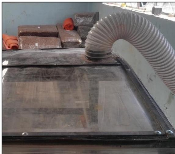
*Figura 54* Extracción y conducción de polvo químico desde la cabina. Elaborado por: Investigador
