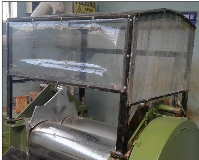
Figura 45 Cabina de Extracción de Polvo Químico. Elaborado por investigador.
