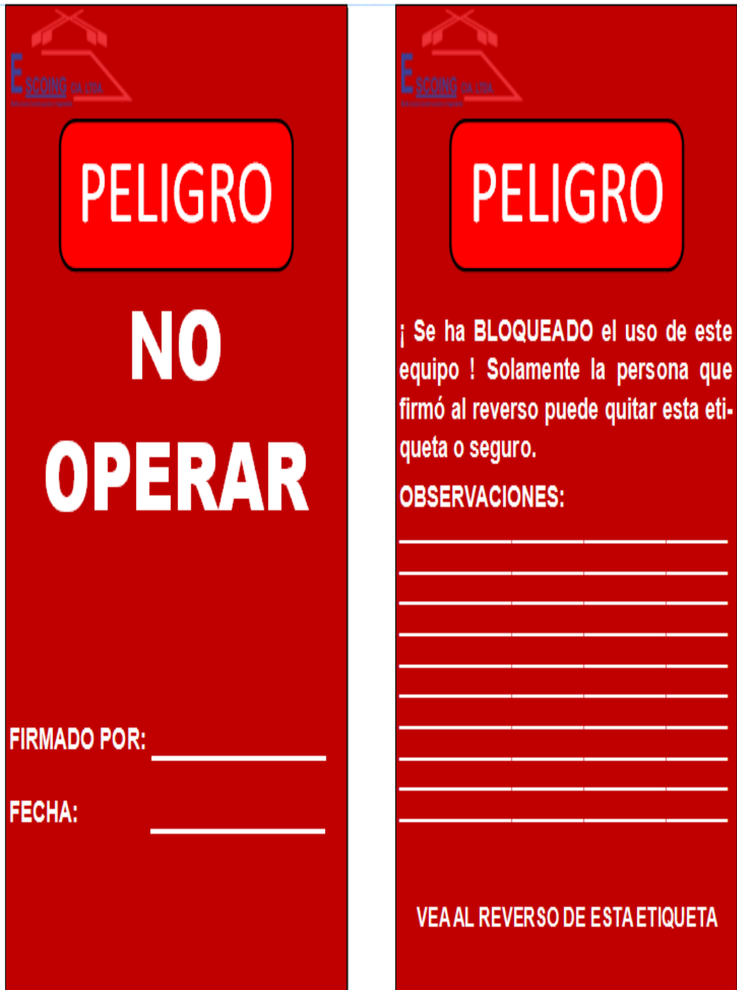
Gráfico 24. Tarjeta de bloqueo de equipos. Sistema visual de identificación y señalización que tiene como propósito advertir el bloqueo o la inmovilización de un equipo, maquinaria, instalación o circuito de proceso.
