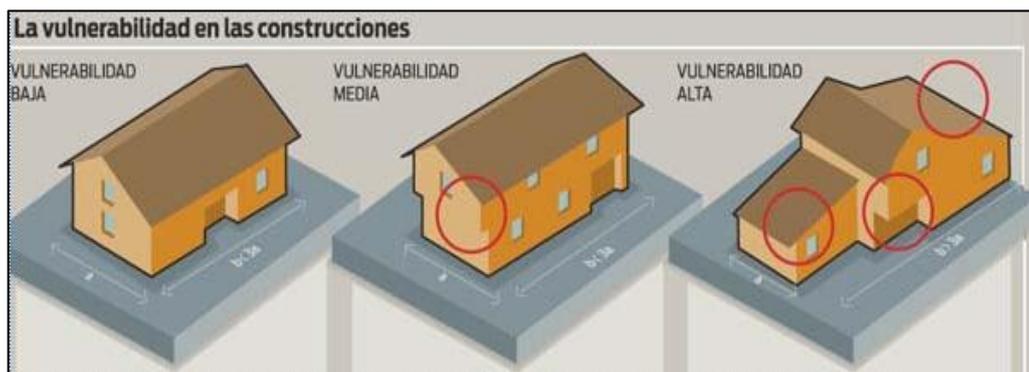
*Figura 2-4* Explica que la **vulnerabilidad baja** en las construcciones es cuando su forma es regular y aproximadamente simétrica, **vulnerabilidad media** posee alguna forma irregular en la planta o en la altura, **vulnerabilidad alta** cuando el largo es mayor que 3 veces el ancho. Fuente: WordPress y Smartline. (Octubre de 26 de 2013). *Sismoresistentes: Casas a prueba de terremotos*. Recuperado el 2017, de <http://miscasasmodernas.com/tag/sismorresistente/>
