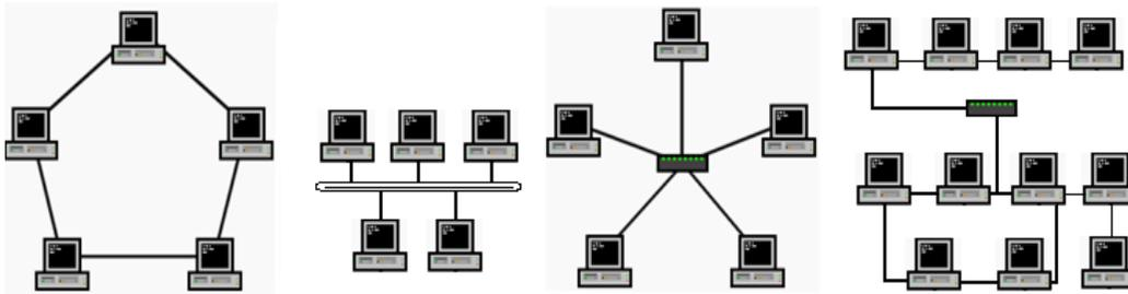
Figura 6. Topologías de red. a) Topología Anillo. b) Topología Bus. c) Topología Estrella. d) Topología mixta. [40]
