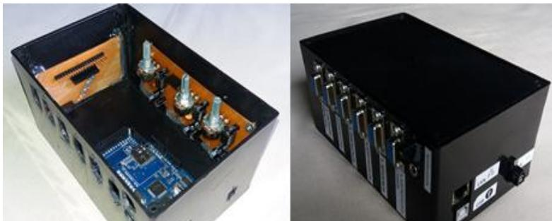
Figura 56. a) Ubicación de las placas en el Módulo Principal. b) Módulo Principal ensamblado. Fuente: Investigador.
