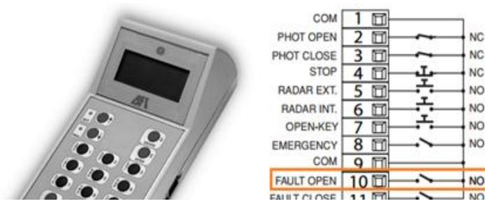
Figura 38. a) Programador UNIPRO. [80] b) Diagrama de pulsadores y switches del sistema VISTA SL. [81]
