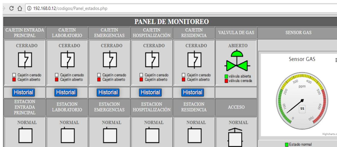
Figura 61. Panel de monitoreo visualizada en un navegador web. Fuente: Investigador.
