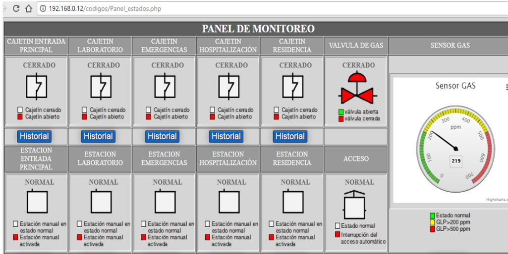
Figura 62. Notificación de fuga de gas. Fuente: Investigador
