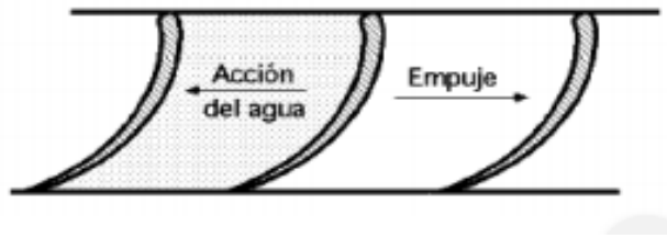
Figura 2.7. Esquema del funcionamiento de turbinas de reacción
