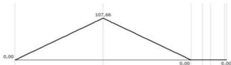
Figura 3.5. Diagrama de momento flector del eje.
