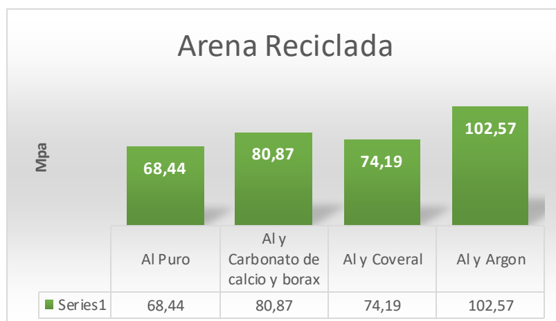
Figura 18: Ensayo a tracción Arena reciclada resultados generales.
