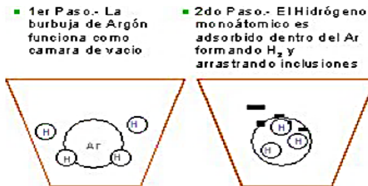
Figura 11: Ejemplo de desgasificado con argón
