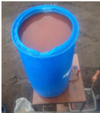
**Imagen 27.** Reposición de material filtrante turba, para continuar con el proceso de filtración.
