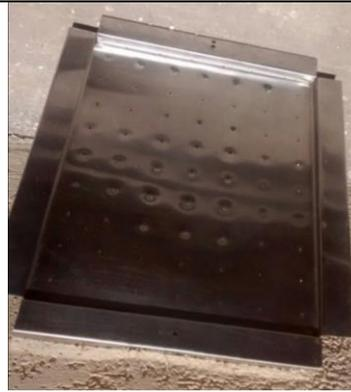
**Imagen 14.** Plancha difusor de agua residual, distribuido para todo el área del recipiente filtro (plancha de tol galvanizado).
