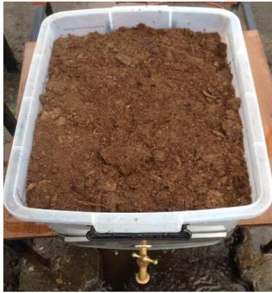
**Imagen 25.** Reposición de material filtrante turba, para continuar con el proceso de filtración.
