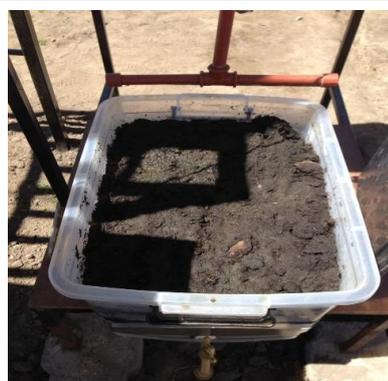
**Imagen 24.** Material filtrante turba presenta mal olor y deterioro, apta para ser reemplazado la turba.
