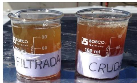
**Imagen 12.** Diferencia entre agua residual y agua filtrada
