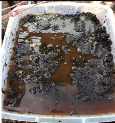
**Imagen 13.** Material filtrante (Turba) presenta deterioro y descomposición en sus 45 días de filtración.
