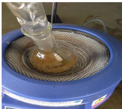
**Imagen 21.** Proceso de hervir aceite y grasas en la maquina Manta Electro Termal – Laboratorio FICM-UTA.
