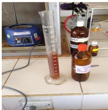
**Imagen 17.** Colocar 250 ml de muestra de agua residual filtrada para análisis de aceites y grasas.
