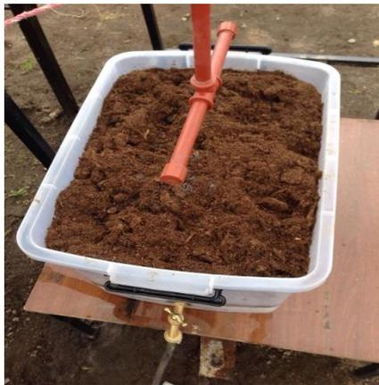
**Imagen 7.** Colocación de material filtrante (Turba) en el recipiente filtro.
