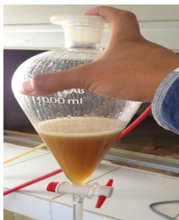
**Imagen 19.** Mezclar muestra con hexano y ácido sulfúrico para análisis de aceites y grasas – Laboratorio FICM-UTA.
