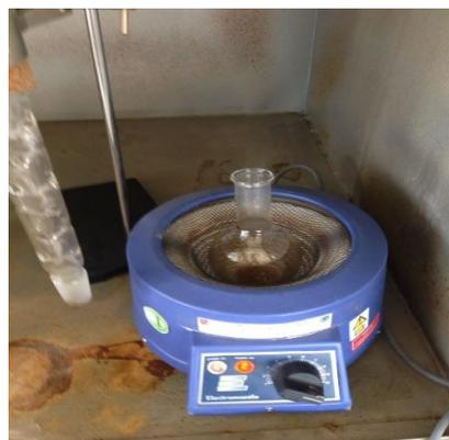
**Imagen 22.** Secado y evaporación de hexano del análisis aceite y grasas a temperatura 100°C – Laboratorio FICM-UTA.
