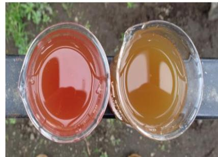
**Imagen 28.** Comparación de agua residual vs agua filtrada a los 55 días de filtrado.
