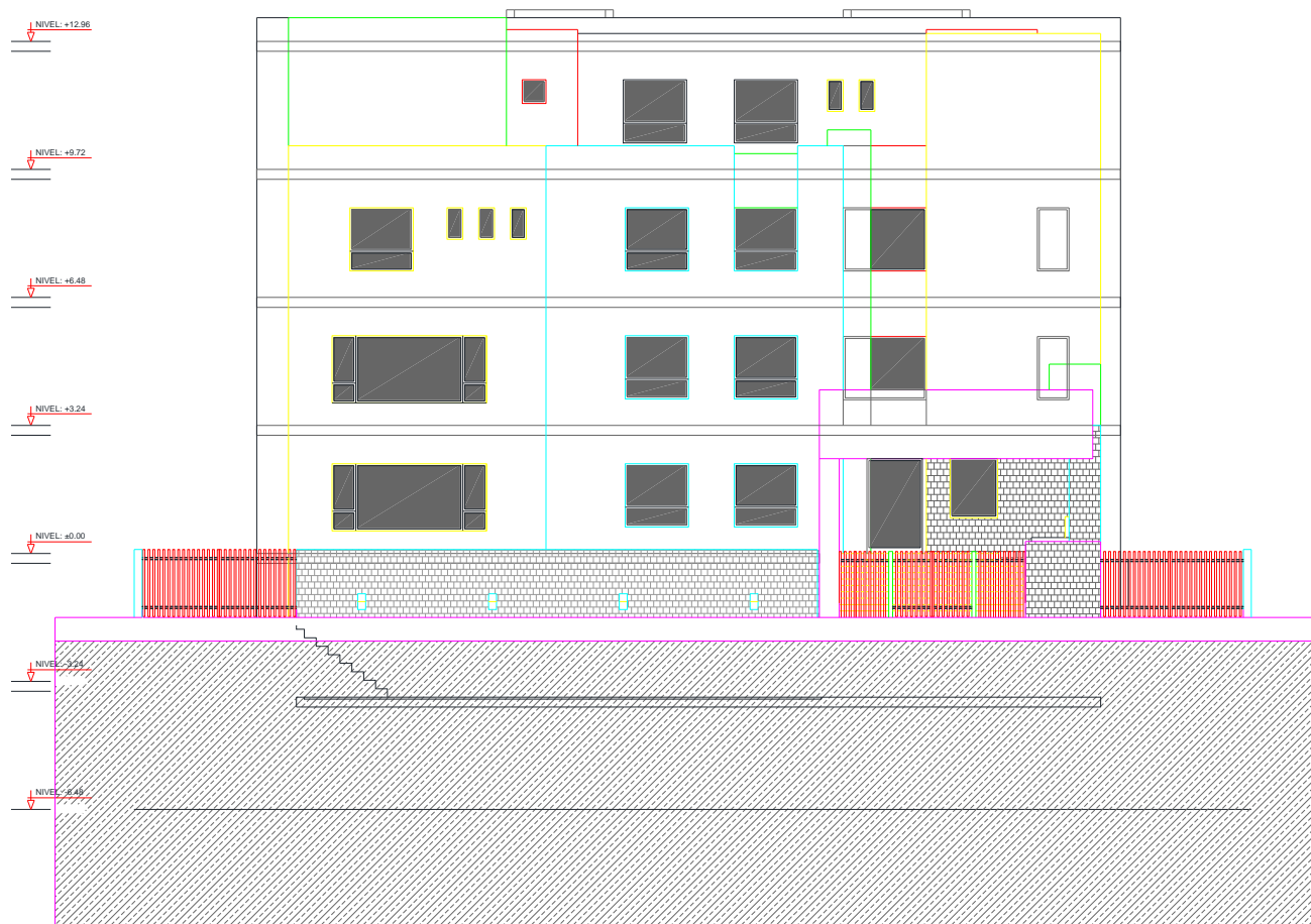
Figura 4.7. Elevación Sur (fachada frontal) del edificio “Ciurana” colindante con la calle Olmedo, en el que se puede evidenciar la configuración irregular en elevación conformado por seis plantas.
