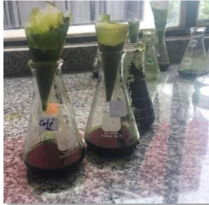
Figura 14. Extractos de aliso y café destilado con papel filtro en Erlenmeyer de 125ml Elaborado: Paredes, 2017.
