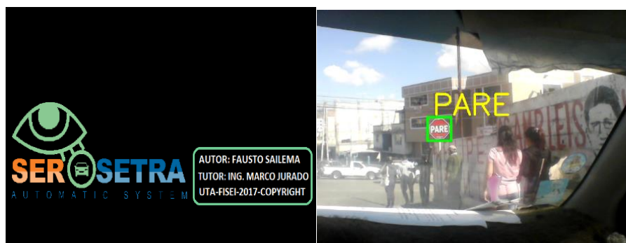
Figura A.7. Sistema SERSETRA reconociendo señal PARE
