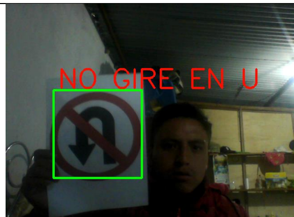
Foto 4: RECONOCIMIENTO SEÑAL PROHIBIDO EN U
