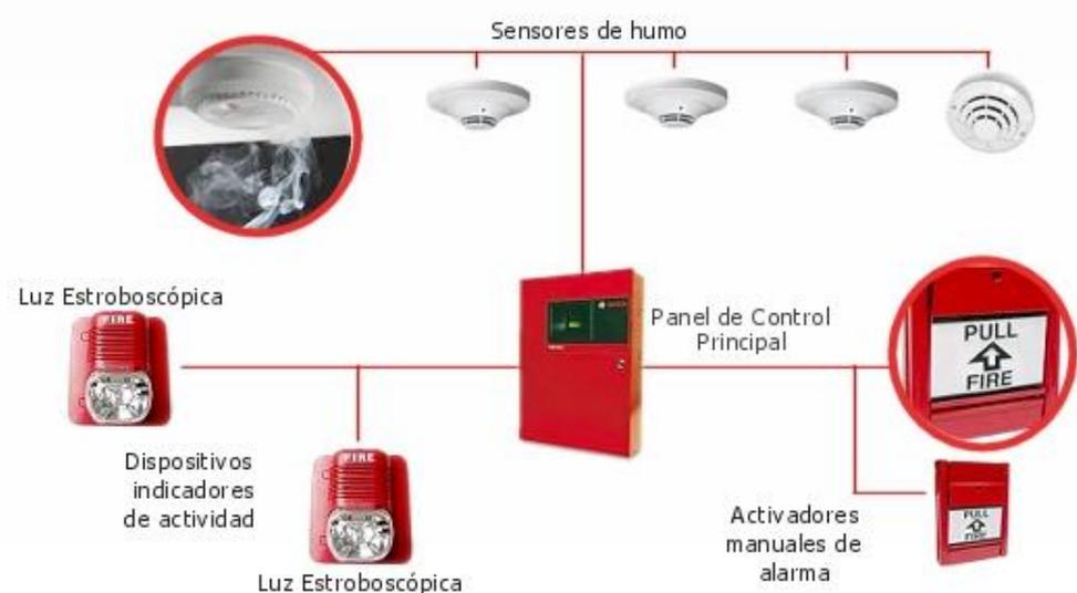
Figura 17: Esquema general de un sistema de alarma contra incendios [31]
