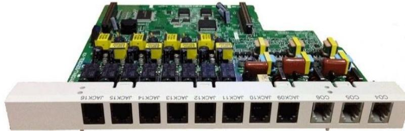
Figura 32: Módulo de Expansión KX-TE82483 [41]
