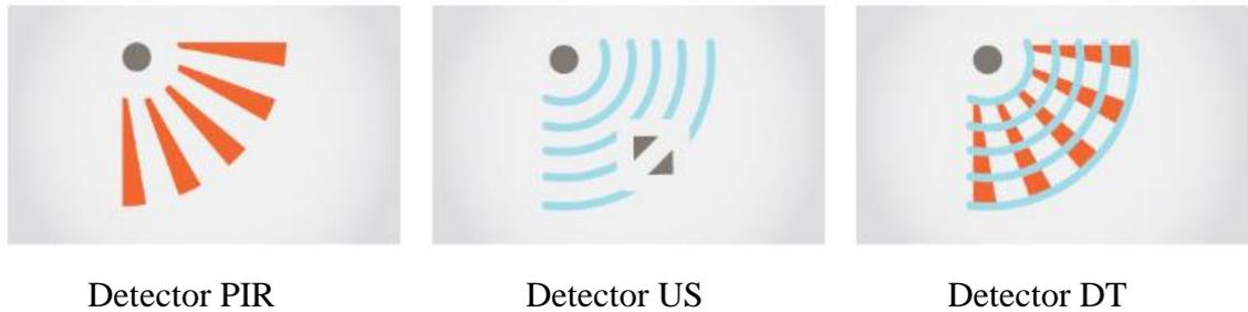
Figura 80: Tecnologías de empleo en sensores de movimiento [69]
