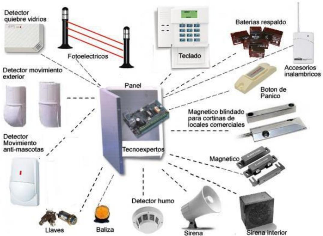
Figura 20: Elementos de un sistema de alarma de intrusión [32]
