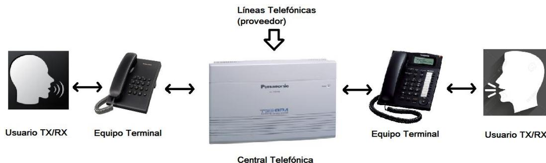
Figura 30: Esquema general de un sistema de telefonía fija
