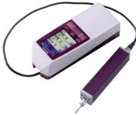
Figura 2. 23 Equipo medidor de rugosidad SJ-210 [17]
