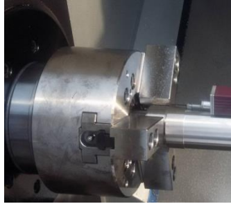
Figura 3. 29Foto de Rugosímetro en la probeta
