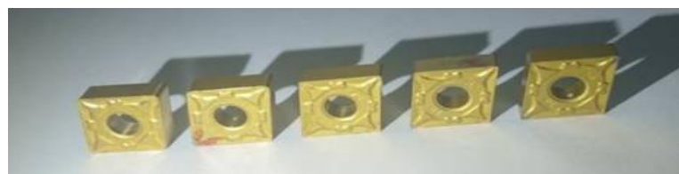
Figura 3. 32 Insertos de metal duro flancos desgastados
