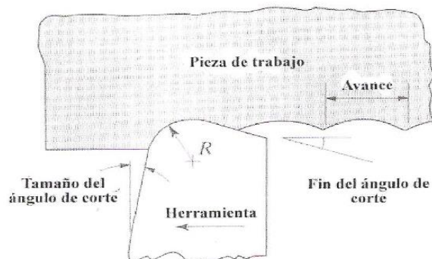
Figura 2. 21 Marcas producidas por la herramienta de corte [13]
