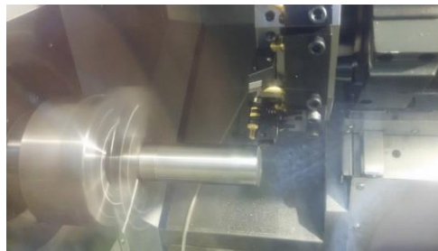
Figura 3. 31 Mecanizado del acero inoxidable para obtención de datos de desgaste
