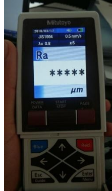
Figura 3. 27 Pantalla de rugosidad media del equipo Mitutoyo SJ-210
