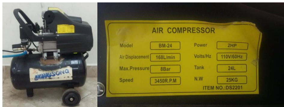
Figura 3. 6 Compresor con su placa de características
