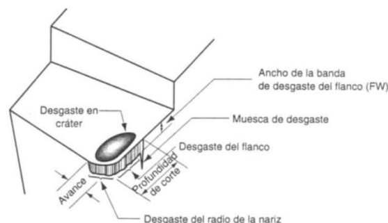
Figura 2. 19 Desgaste en la herramienta de corte [9]
