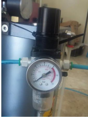
Figura 3. 7 Unidad de mantenimiento de aire
