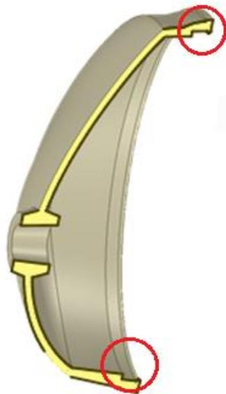
**Figura 12.** Pestaña para ensamblar la tapa.
