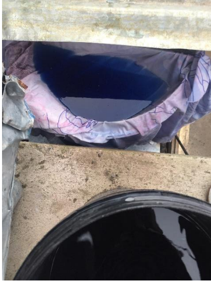
Ilustración 5: Pre filtrado con una sábana, cedazo metálico
