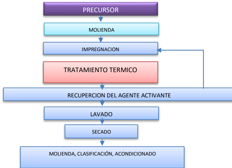
Figura 3. Diagrama de la activación química
