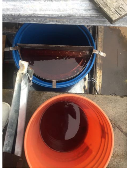
Ilustración 5: Pre filtrado con una sábana, cedazo metálico
